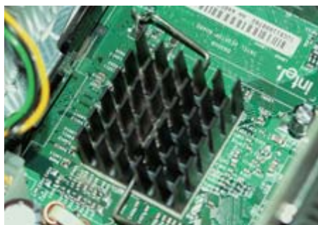
▲ Радиатор на чипсете гораздо больше привычного
