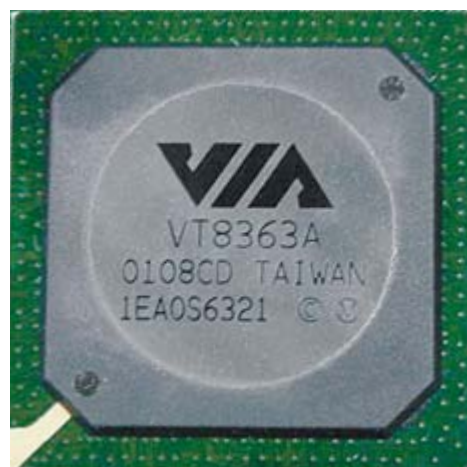
▲ Проблемный северный мост. Этот чип является причиной возникновения так называемой проблемы «перезагрузки» на Athlon C
