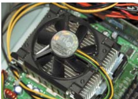
▲ Кулер на процессоре тоже впечатляет размерами, хотя его радиатор на самом деле небольшой
