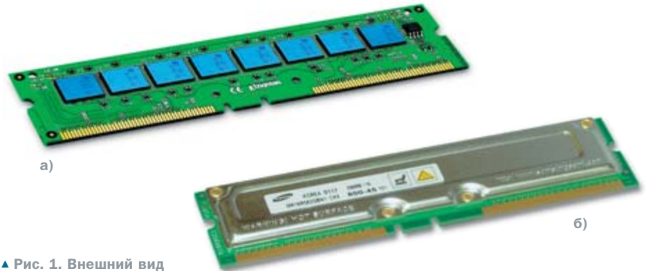
▲ Рис. 1. Внешний вид RIMM-модуля: а) без чехла, б) в металлическом чехле
