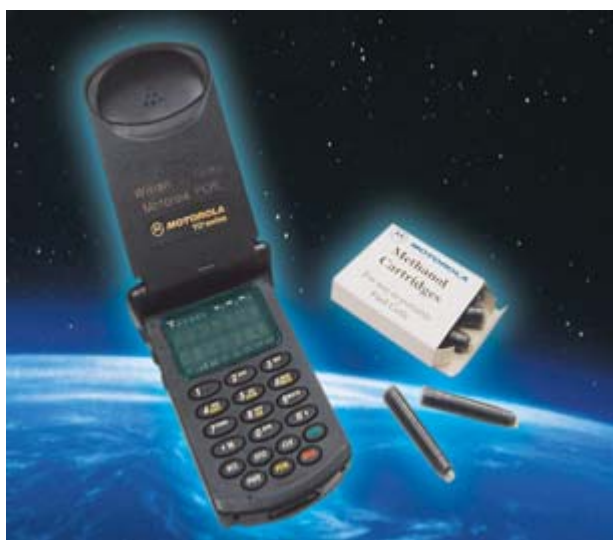
▲ Миниатюрные патроны: метаноловые патроны для заправки топливных элементов не превышают по своим размерам патроны для заправки обычных перьевых ручек
