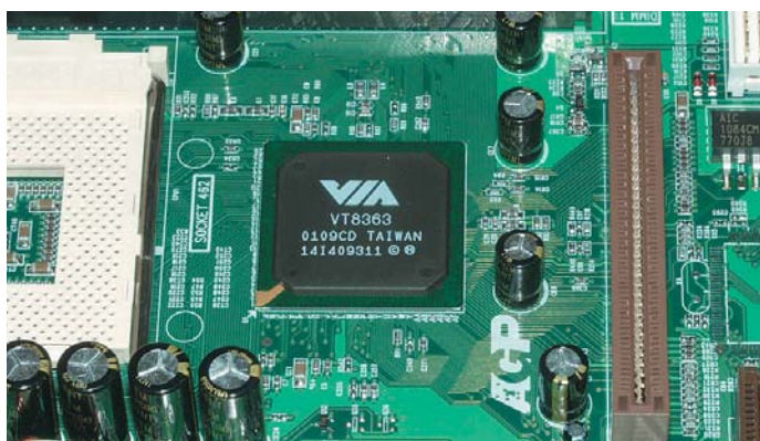
▲ Немодифицированный северный мост чипсета VIA KT133. Из-за связи севера и юга через шину PCI прокачка данных ограничена, и микросхема северного моста не нуждается даже в пассивном охлаждении
