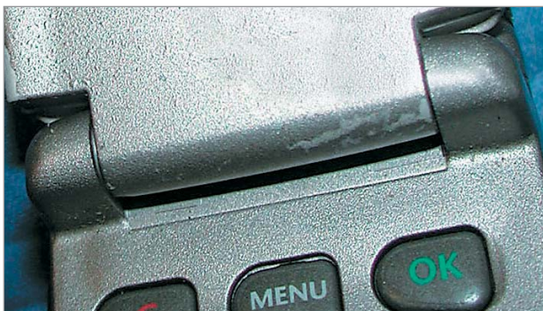
▲ Слабое место всех аппаратов с флипом — соединение. Чаще всего это место разбалтывается у Motorola Star-Tac и у Samsung. Если флип неактивный, то его поломка, как правило, на работе телефона не сказывается.
