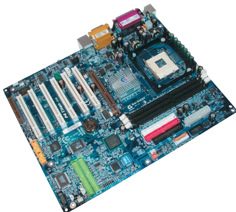
▲ Плата GA8IRXP обеспечивает гибкое деление частоты для шин AGP и PCI
