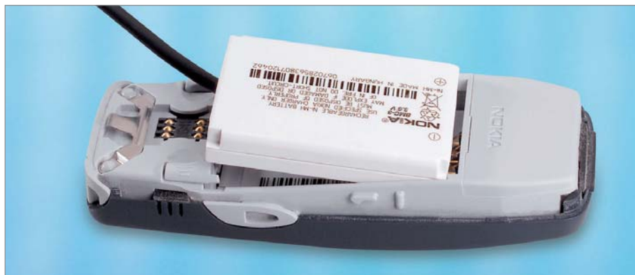
▲ Кабель для передачи данных теперь под крышкой: у каждой серии мобильных телефонов Nokia собственный тип разъема и кабеля для передачи данных. В серии Nokia 33xx разъем находится под аккумулятором
