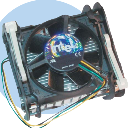
▲ Негромкий и эффективный: стандартный вентилятор Intel для процессора Northwood
