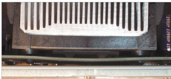
▲ Внушающий страх изгиб платы FIC VCIS, получившийся после монтажа кулера
