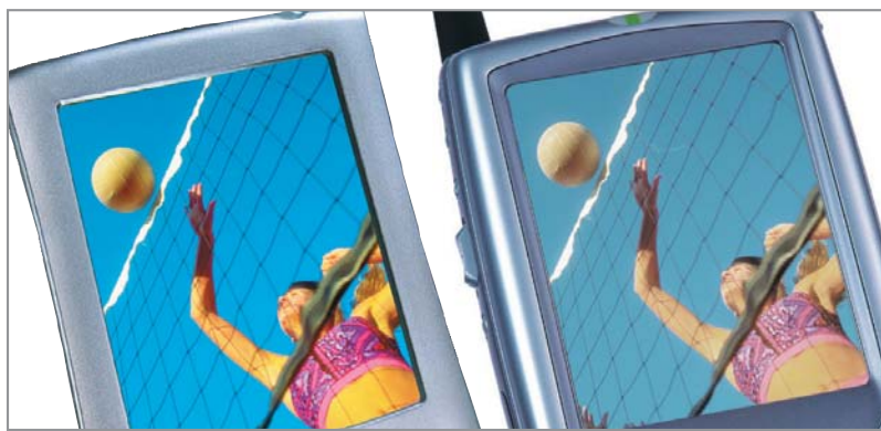
▲ Рис. 2а, б. Превосходство очевидно. Изображение на OLED-дисплее (слева) и LCD (справа)
