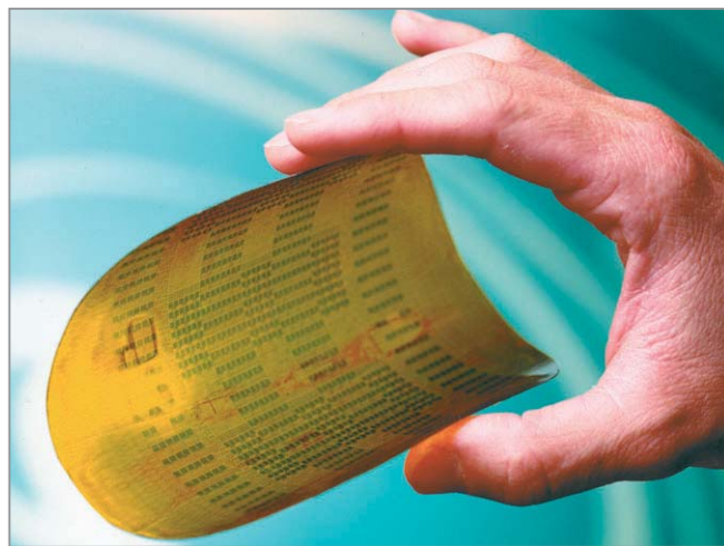
▲ Рис. 4. Дисплеи, созданные по технологии LEP, используют в качестве подложки пластик и могут изгибаться
