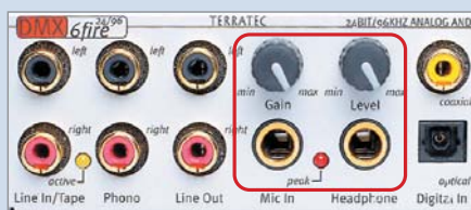
▲ Удобство на практике: выносная панель имеет ручки регулирования громкости микрофона и наушников
