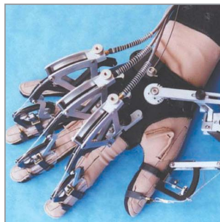
« Рис. 1. Перчатка CyberGlove с устройством обратной связи CyberGrasp позволяет почувствовать виртуальные предметы
