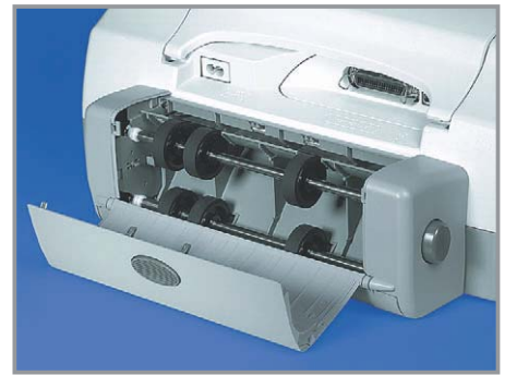
▲ Полезное дополнение: специальное устройство в принтерах 900-й серии автоматически переворачивает бумагу и позволяет тем самым печатать на обеих сторонах листа
