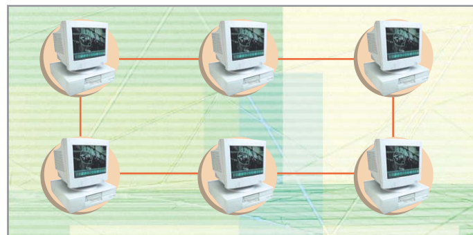
▲ Топология «кольцо» нечасто применяется в домашних сетях из-за высоких требований к надежности рабочих станций
