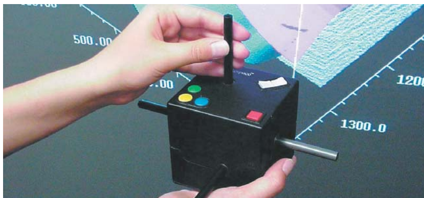
▲ Устройство Space Controller компании 5DT регистрирует не только вращение, но и изменение высоты
