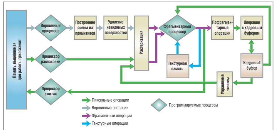
▲ Рис. 1. Приблизительная схема работы OpenGL 2.0
