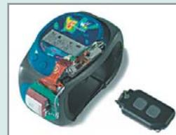
пульт оператора, который имеет возможность вызвать полицию из ближайшего участка. Кроме того, есть специальный замок для закрепления устройства на руке, который при попытке его открытия посылает аварийный сигнал.
