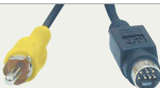
▲ Рис. 6. Переходник mini-DIN 7-pin — «тюльпан»
