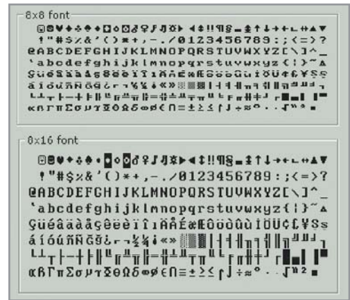
Рис. 9. С помощью ATI BIOS Editor можно легко увидеть, что собой представляют шрифты, зашитые в BIOS видеокарты
