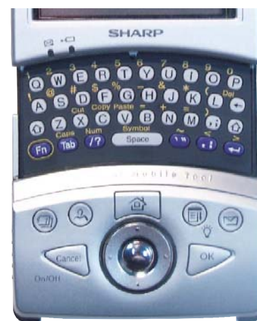
▲ Выдвижение клавиатуры не нарушает работы кнопок на панели управления, что позволяет, например, использовать кольцо консоли и клавишу «Shift» для выделения текстового блока
