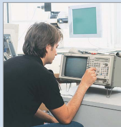
▲ Теперь они стали побыстрее: инженер-испытатель измеряет с помощью фотодиода и осциллооскопа время отклика TFT-экрана
