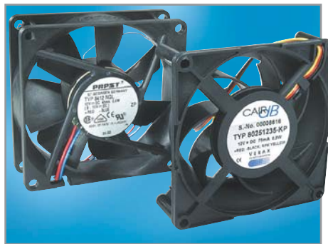
▲ Вентиляторы от Verax и Papst работают тихо, однако по-настоящему эффективной можно признать лишь работу последнего
