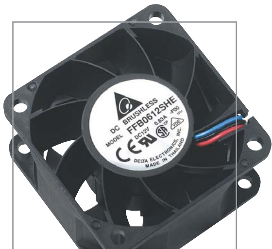
▲ Если вентилятор потребляет больше тока, чем дает материнская плата, это может привести к «летальному исходу»
