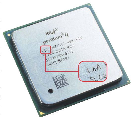
▲ Мы покупаем «А»: эта буква в маркировке позволяет отличить ядро Northwood от устаревшего (хотя и имеющего такую же частоту) ядра Willamette
