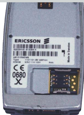
▲ В этом аппарате SIM-карта вдвигается и прижимается направляющими (T28)
