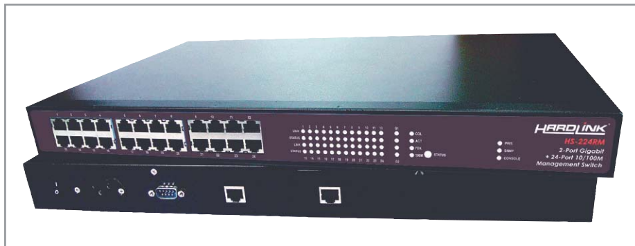
▲ Мощные многопортовые коммутаторы имеют стандартную ширину для удобства монтажа в стойку с другим оборудованием
