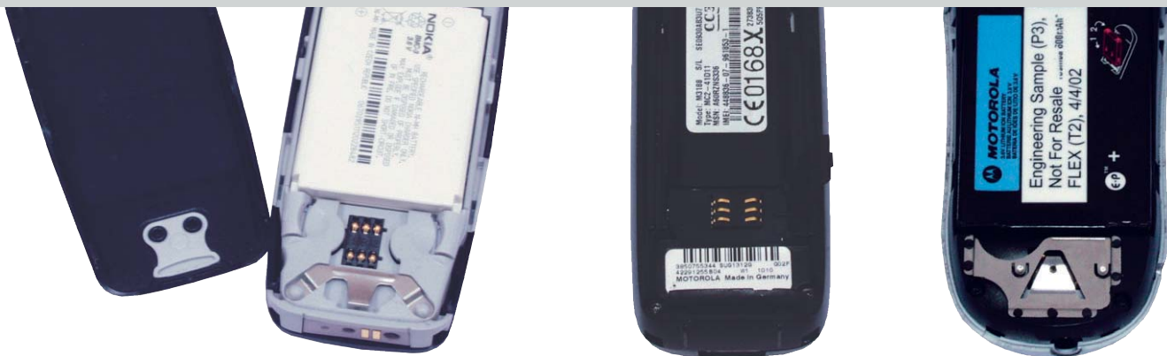
▲ В телефонах Nokia SIM-карту дополнительно прижимает задняя крышка телефона
