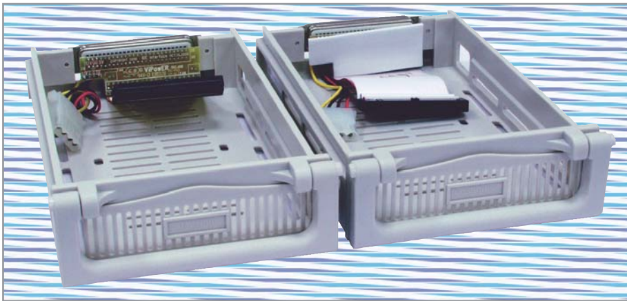
▲ Часть Mobile Rack имеет изолирующую прокладку на интерфейсном переходнике, в то время как у других аналогичных моделей ее почему-то нет
