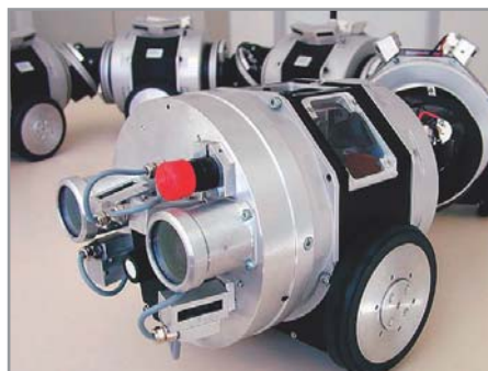
▲ Трубочист. «Макро» на полигоне, где испытываются роботы для работы в трубах. Эта «змея», запущенная в систему трубопроводов, должна будет самостоятельно выявлять поврежденные участки
