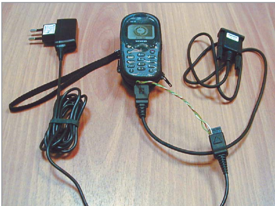
▲ Одно из самых простых решений по «доработке» кабеля. Понятно, что любое неосторожное движение при перепрошивке аппарата приведет к необходимости дорогостоящего посещения сервис-центра
