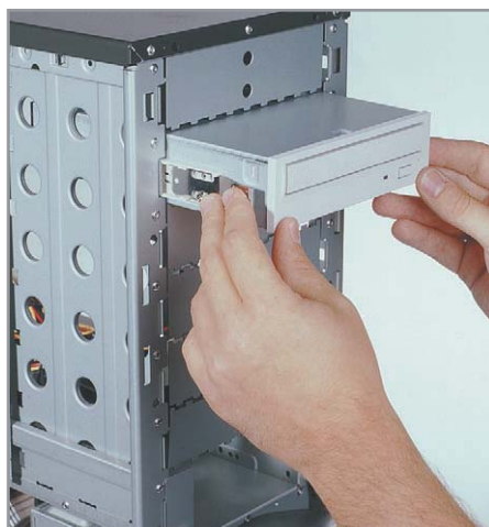
▲ Привод на салазках: после того как к DVD-рекордеру прикручены специальные салазки, он легко задвигается внутрь 5,25-дюймового отсека
