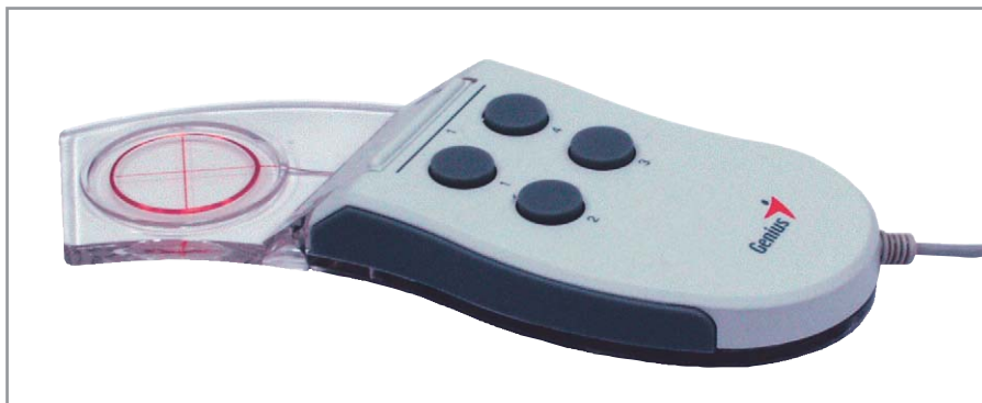
▲ Назвать подобный манипулятор мышью довольно сложно. Такие устройства используются в узкоспециализированных приложениях для проектирования типа известной системы AutoCAD
