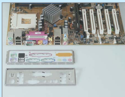
▲ Меняем заглушки: разноцветные заглушки слотов, установленные в корпусе, можно заменить однотонными, прилагающимися к плате
