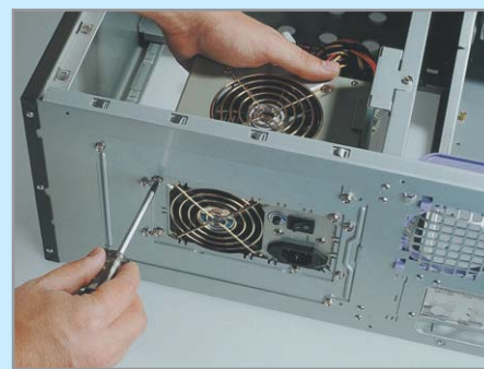
▲ Установка блока питания: в корпусе нашего КСМ Chieftec TA-10BD блок питания крепится вертикально
