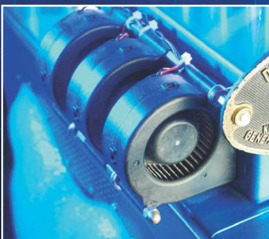
▲ Быстрая тройка: радиатор, решетка от «Фольксвагена» Scirocco, тройной радиальный вентилятор Nidec
