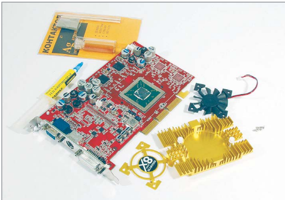
▲ Рис. 2. Все, что доктор прописал: необходимые детали для переделки Radeon 9500 64 Мбайт
