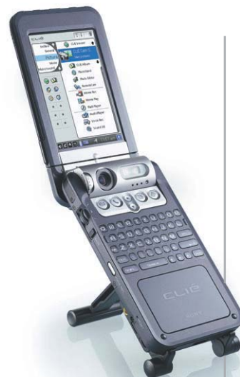
КПК с двухмегапиксельной камерой: Sony NZ90 с операционной системой Palm 5.0 и интерфейсом Bluetooth.
