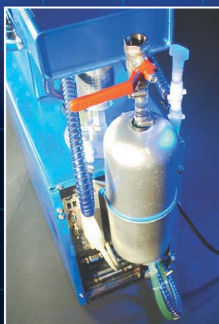
▲ Баллон из туристического автомобиля теперь работает расширительным бачком в системе охлаждения компьютера
