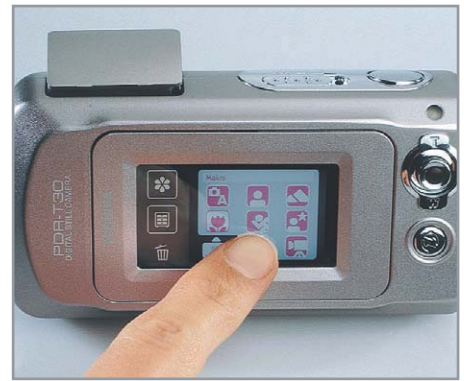
▲ Toshiba T30: с помощью сенсорного дисплея вы путешествуете по меню. Дисплей заменяет механические элементы управления
