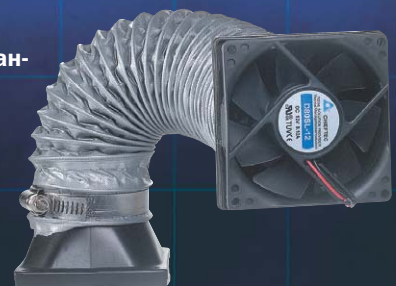
▲ Воздуховод подает «заборный воздух» прямо к процессору и смотрится как нечто космическое
