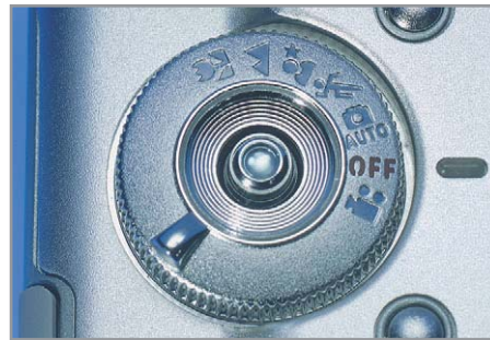
▲ Kodak LS443: вследствие того, что регулировочное колесо у этой камеры чересчур легко перемещается, отсутствует точная фиксация в нужном положении и настройки легко сбиваются
