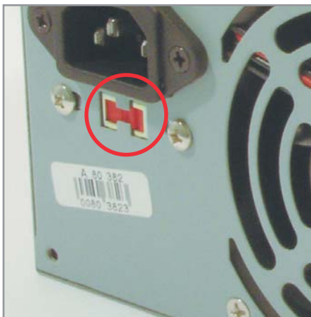
▲ На некоторых БП можно встретить переключатель, позволяющий выбирать рабочее напряжение
