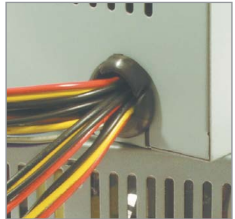
▲ Важной деталью блока питания является наличие специализированной пластиковой втулки, через которую проходят провода
