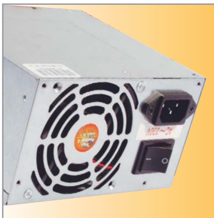
▲ Любой качественный блок питания должен иметь наклейку с характеристиками и общий выключатель
