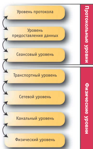
▲ Базовая модель OSI — схема уровней, используемых при взаимодействии компьютерных систем
