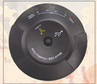
▲ К этому хабу можно подключить сразу шесть FireWire-устройств и пять USB
