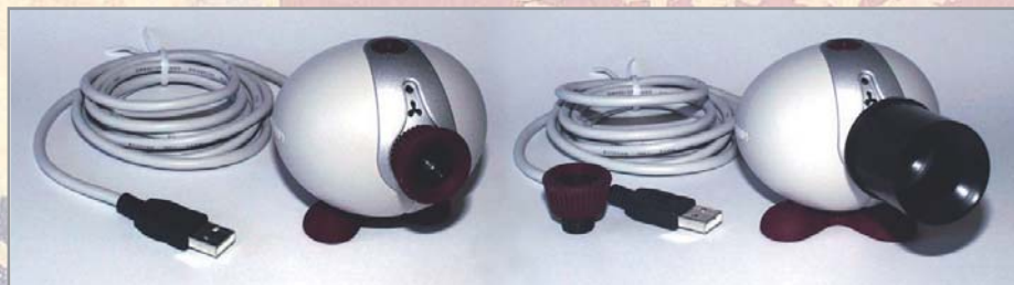
■ Приложив усилия, можно получить из стандартной камеры (слева) научное оборудование для наблюдения за космическими объектами (справа)
