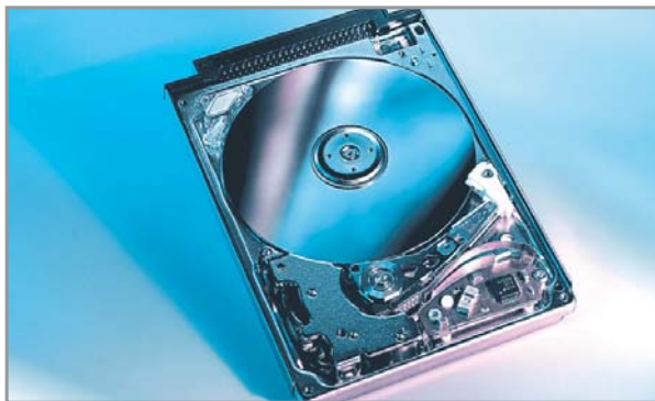
◀ Винчестер Toshiba MK2003GAN, выполненный в 1,8-дюймовом формате, имеет емкость 20 Гбайт
