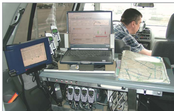
▲ Передвижная лаборатория мониторинга сети («Билайн»). Компьютеры, специальное оборудование, полтора десятка работающих телефонов, GPS
