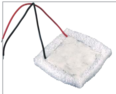
▲ Элемент Пельте, размещенный в специальном поролоновом кожухе
