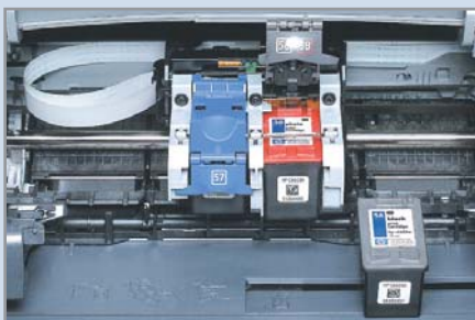
▲ Универсальный фотопринтер: если вы замените фотокартридж картриджем с черными пигментными чернилами, фотопринтер превратится в офисный струйник
