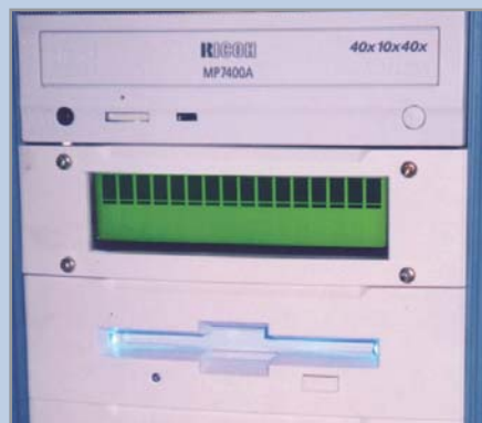
▲ О правильном подключении дисплея свидетельствует тестовая строка из черных квадратов
