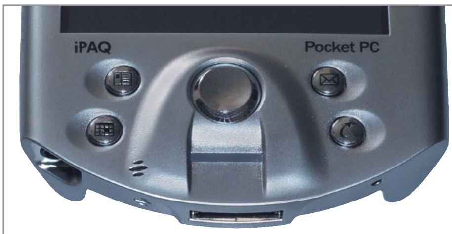
▲ Биометрический сканер отпечатков пальцев входит в стандартную комплектацию HP iPAQ H5450
