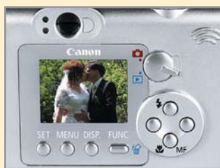
▲ Дисплей смонтирован под прозрачной пыленепроницаемой крышкой
