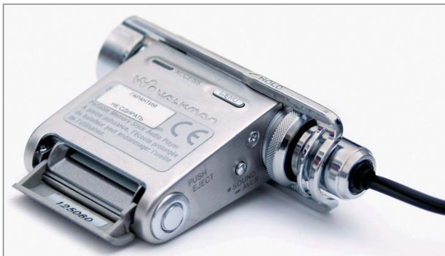
▲ Слот для карт расширения памяти на плеере Sony NW-MS70D расположен удобно и защищен закрывающейся крышкой
