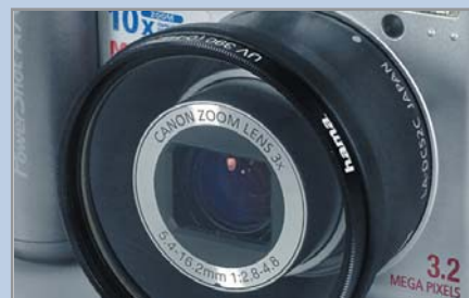
▲ Canon A70: адаптер для светофильтра, теле- и широкоугольных линз
