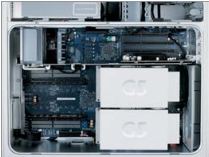
▲ «Дуэт»: под импозантными радиаторами скрыты два процессора производства IBM с тактовой частотой 2 ГГц каждый
