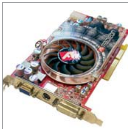
▲ У Radeon 9800 XT компактная система охлаждения, благодаря которой карта занимает один слот
