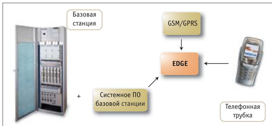
▲ Базовые станции RBS2206 разрабатывались для сетей третьего поколения. Естественно, они готовы и к поддержке EDGE
