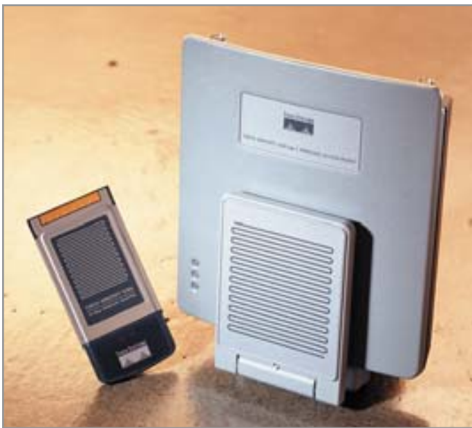
▲ Точка доступа Cisco Aironet 1200 полностью совместима со стандартами IEEE 802.11a, 802.11b и 802.11g и поддерживает пропускную способность до 55 Мбит/с
