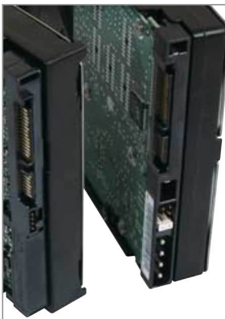
▲ Не все Serial ATA-накопители оснащаются двумя разъемами питания. У Seagate разъем только один
