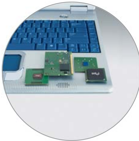
▲ Технология Intel Centrino состоит из трех компонентов: процессор Pentium M, набор микросхем Intel 855 и решение беспроводного доступа Intel PRO/Wireless 2100
