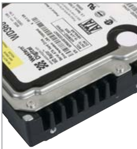
▲ Специальные теплоотводящие радиаторы используются только на жестких дисках WD Raptor
