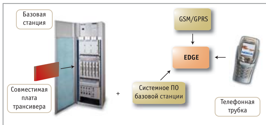
▲ В базовых станциях RBS2202 и 2102 производства Ericsson функциональность EDGE обеспечивается установкой платы расширения EDGE TRU
