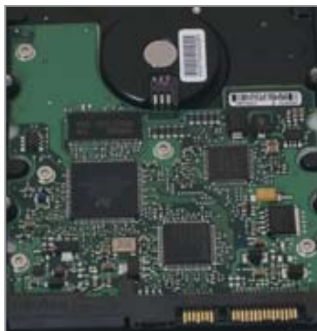
▲ Печатная плата дисков Seagate изобилует различными элементами, которые легко повредить
