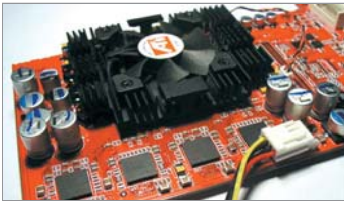
▲ Расположение питания делает невозможной установку стандартных радиаторов для памяти
