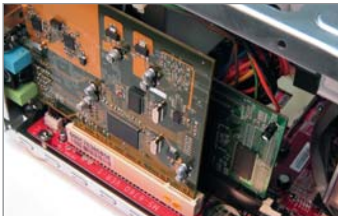
▲ Терпение и труд: две карты расширения — ТВ-тюнер и видеоадаптер — с превеликим трудом устанавливаются в миниатюрный корпус
