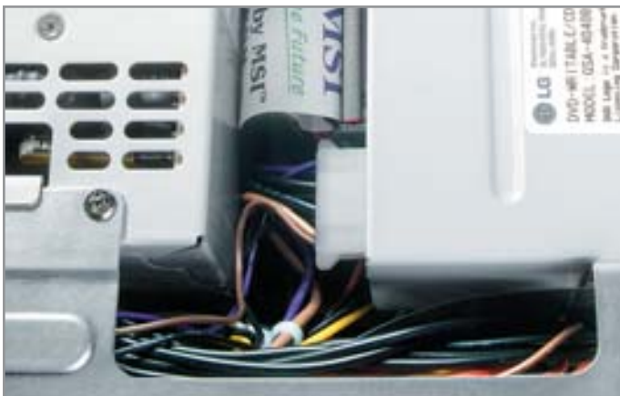
▲ Автономность на первом месте: этот штекер запитывает DVD-рекордер напрямую, что позволяет ему работать даже при выключенном компьютере
