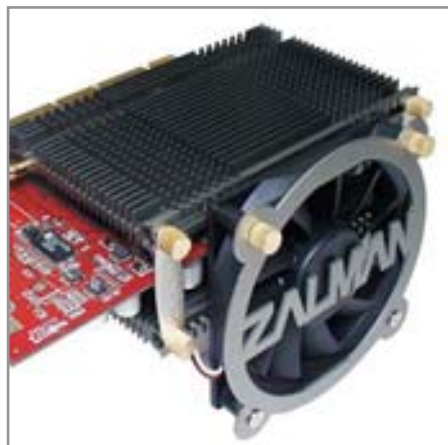
▲ Дополнительный вентилятор для системы охлаждения Zalman ZM80C-HP остудит даже Radeon 9800 XT
