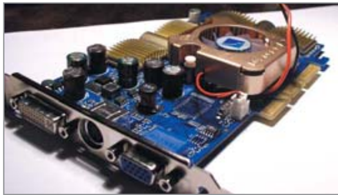
▲ GeForce FX 5600 с установленным холодильником Пельтье бьет рекорды производительности
