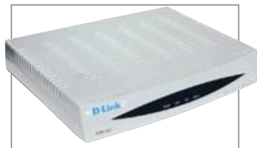
▲ Максимальная скорость загрузки данных DCM-200 — 42,88 Мбит/с
