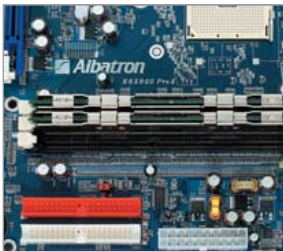
▲ Albatron KX800 Pro II: максимальная тактовая частота RAM в 400 МГц возможна только при наличии двух модулей
