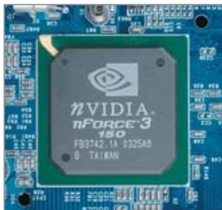
▲ NVIDIA nForce3 150: новый чипсет совмещает функции северного и южного мостов в одном чипе
