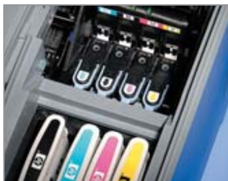
▲ HP Business InkJet 1100D: и чернила, и печатающие головки могут заменяться по отдельности
