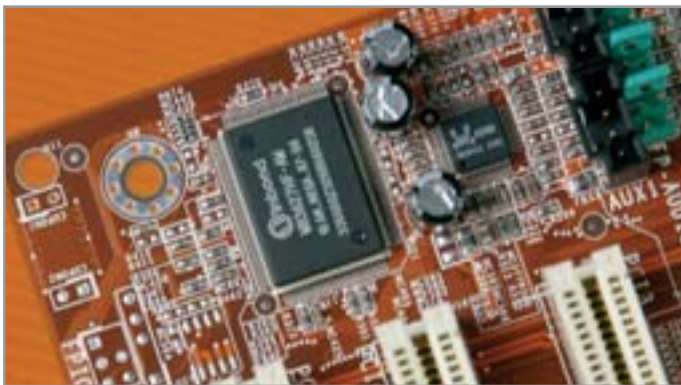
▲ Благодаря контроллеру от Winbond COM-порты некоторых плат могут работать со скоростью 921 600 бод
