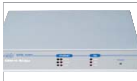
▲ Модем-мост Granch SBNI16B имеет ПО, реализующее функции маршрутизации трафика на MAC-уровне
