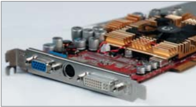
▲ На многих видеокартах уже имеется два видеовыхода: цифровой DVI и аналоговый D-Sub
