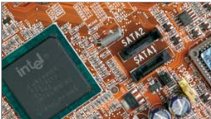
▲ Одной из важных особенностей Intel ICH5 является наличие контроллера Serial ATA
