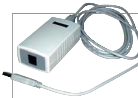
▲ Адаптер IolaPLN USB и телефон подключаются к линии через внешний фильтр (входит в комплект)
