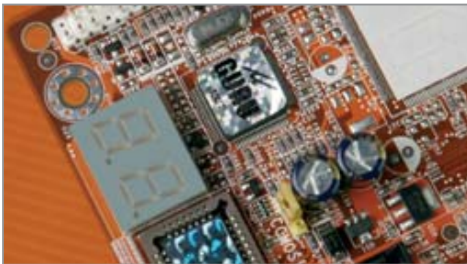
▲ Abit AI7: жидкокристаллический индикатор показывает код произошедшей ошибки
