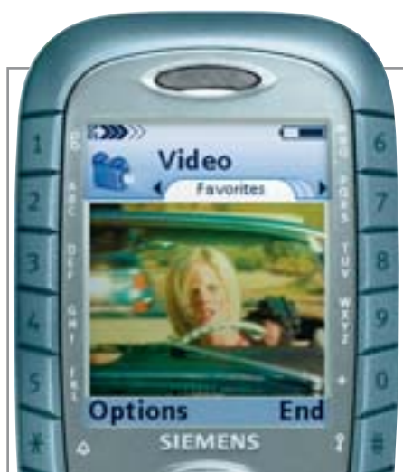
▲ На смартфоне Siemens SX1 установлен экономичный TFD-дисплей
