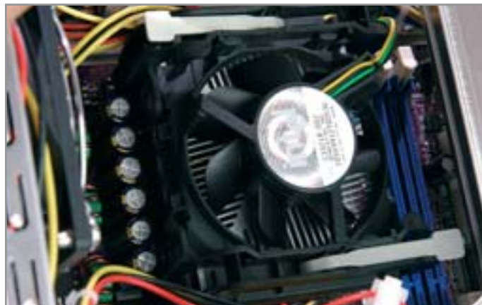
▲ В качестве системы охлаждения D1S4-2 используется стандартный кулер Intel
