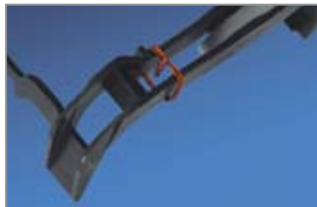
▲ Обмотав медной проволокой крепежную раму кулера, вы снизите риск поломки при сборке системы
