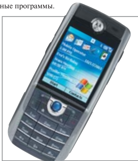
▲ 176x220 точек — «компактный» вариант дисплея на Motorola MPx100 с Windows Mobile 2003 Edition
