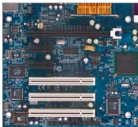
▲ Материнская плата Albatron PX915G Pro имеет как разъемы PCI, так и два вида PCI Express
