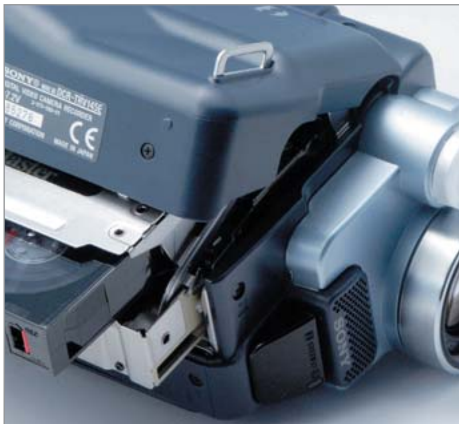
▲ Объемные формы: в модели от Sony для цифровой записи используется кассета Hi8 большого размера, что увеличивает габариты камеры
