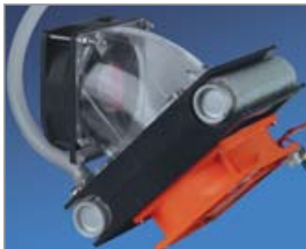
▲ Установка двух вентиляторов на радиатор приведет к снижению температуры охладителя
