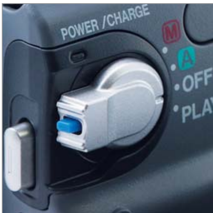
▲ Два режима съемки JVC: если выбрано положение, обозначаемое красной буквой «М», все опции можно устанавливать вручную
