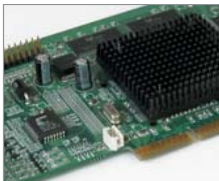
1.2 GeForce2 MX 400 после установки пассивного кулера
