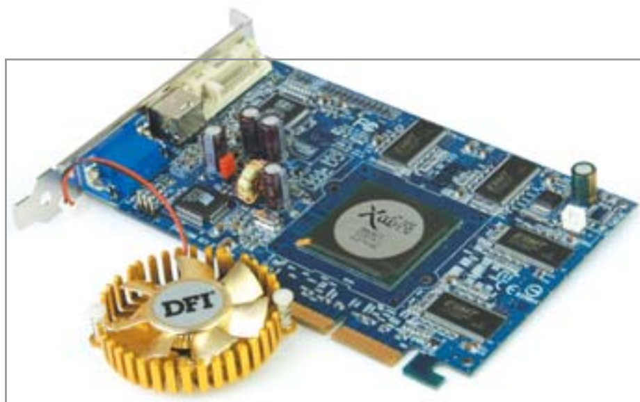
1.1 До установки: DFI Xabre 400 с демонтированным штатным шумным кулером
