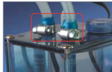
▲ Обмотав изоляционной лентой штуцеры резервуара, вы сведете к минимуму риск протечки
