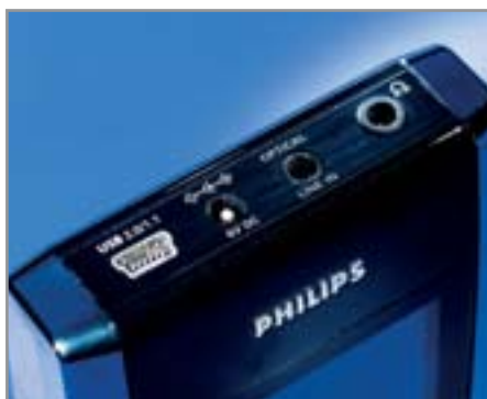
▲ Philips HDD 100 имеет аналоговый и цифровой входы
