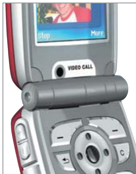
▲ QCIF-камера на Sony Ericsson Z1010 размещена под дисплеем
