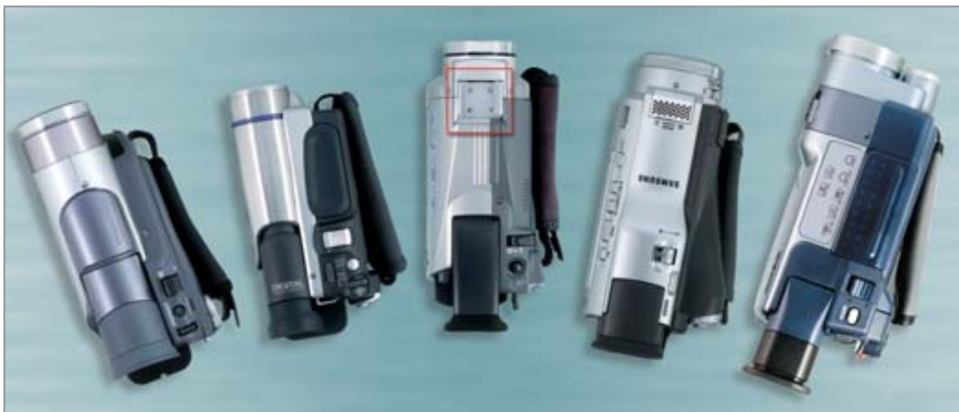
▲ Проблема контакта: у четырех моделей из пяти отсутствует специальный «башмак» для крепления дополнительного оборудования, и лишь у Canon он имеется
