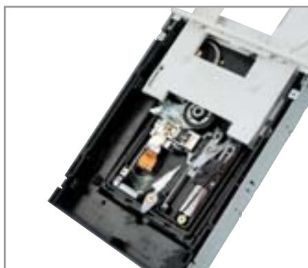
2.3 Не ленитесь выдвинуть лоток и вынуть все осколки диска
