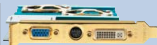
▲ Без адаптера никак: эта видеокарта от Leadtek делает доступным ТВ-вход и выход только через специальный переходник
