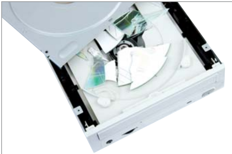
2.2 Обломки inside: разрыв старого или некачественного компакт-диска в современном оптическом приводе — событие рядовое
