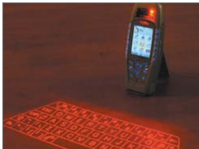
◀ Смартфон Siemens SX1 на базе Symbian OS может работать с виртуальной клавиатурой компании iBiz Technology. Лазерный проектор передает изображение на твердую поверхность, а нажатие клавиши фиксируется без физического контакта
