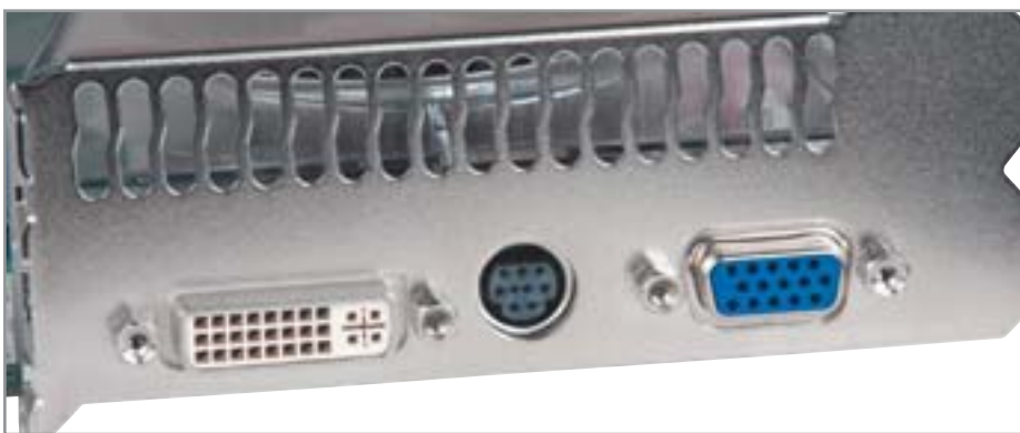
▲ Топ-модели: дорогие видеокарты имеют целый комплект видеовыходов
