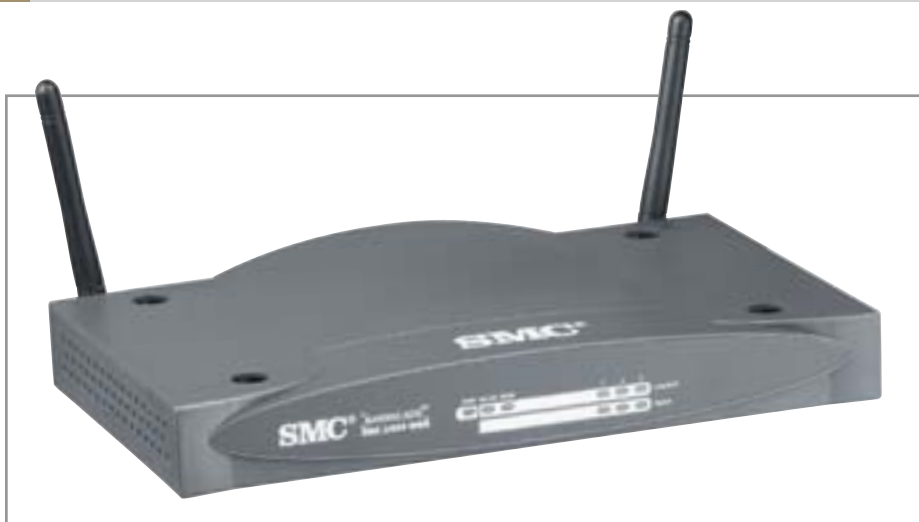
▲ Беспроводная точка доступа Barricade G 2404WBR компании SMC поддерживает 256-битное WEP-шифрование данных
