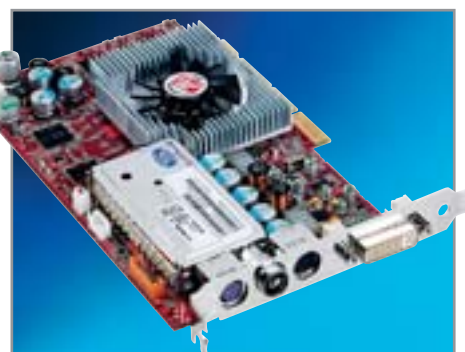
▲ ATI Radeon All in Wonder совмещает в себе функции видеокарты и ТВ-тюнера
