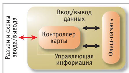
▲ Принципиальная схема флеш-карты с контроллером
