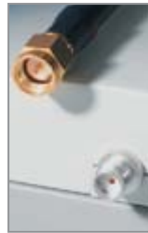
▲ Маршрутизатор (внизу слева) оборудован разъемом SMA-RP, а у антенны (внизу справа) — SMA-штекер
