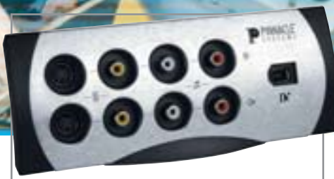
▲ Выносная панель Pinnacle BlackBox оснащена как аналоговыми, так и цифровыми разъемами
