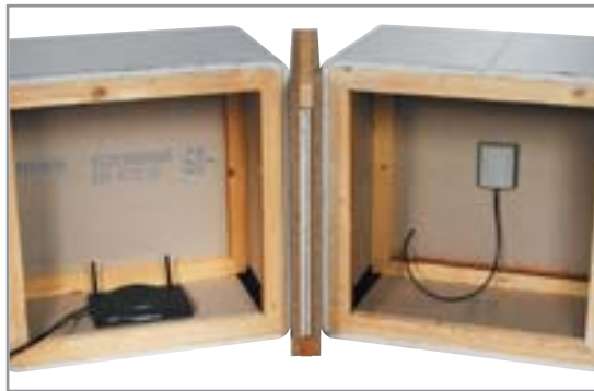
▲ Тестируемое устройство было эффективно прикрыто двойной строительной сэндвич-панелью (гипсокартон с алюминиевой фольгой)
