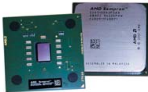
▲ Процессоры семейства AMD Sempron: слева в корпусе Socket 462, справа — Socket 754
