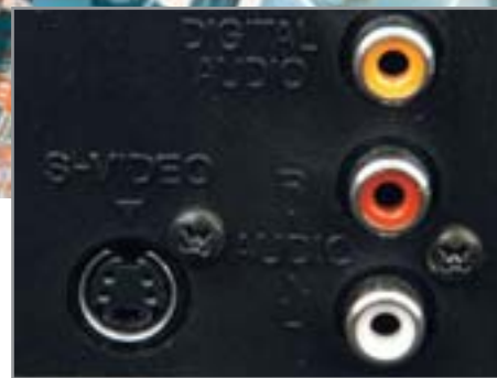
▲ На задней панели всех VHS-видеомагнитофонов есть только аналоговые видеовыходы
