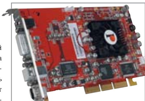
▲ Два в одном: Pinnacle Liquid Edition состоит из блока видеозахвата и видеокарты Radeon 8500
