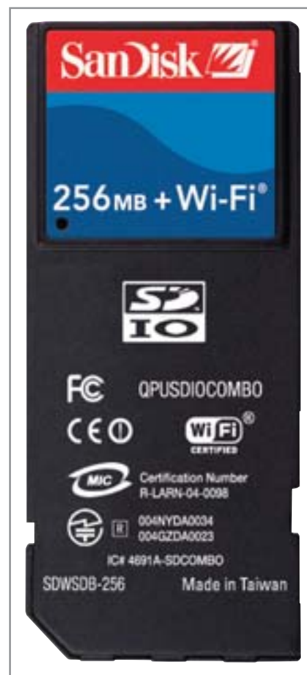
▲ Два в одном: SD-карта от SanDisk совмещает в себе флеш-память с Wi-Fi-адаптером
