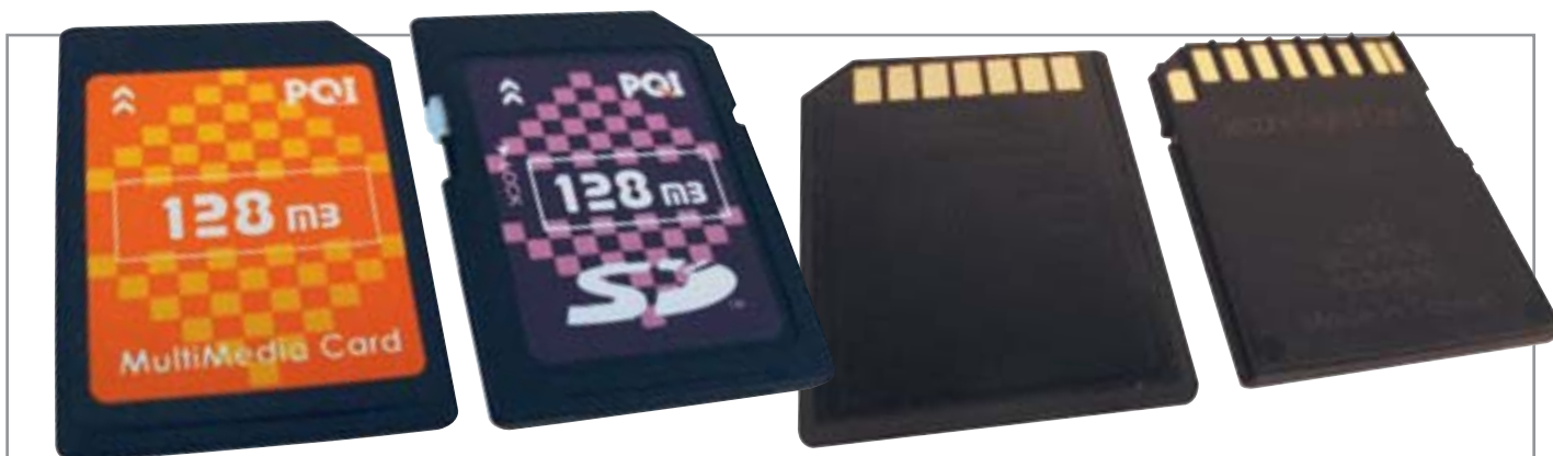
▲ Найдите десять отличий: карточки MMC и SD крупным планом. Карты выполнены в схожих корпусах
