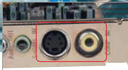
▲ Любой ТВ-тюнер стоимостью от $50 оснащается аналоговыми видеовходами (S-Video и RCA)
