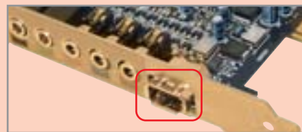
▲ Контроллеры FireWire можно встретить на материнских платах (левый рисунок) и на звуковых картах семейства Audigy (правый рисунок)
