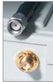
▲ Маршрутизатор (внизу слева) оборудован разъемом SMA-RP, а у антенны (внизу справа) — SMA-штекер
