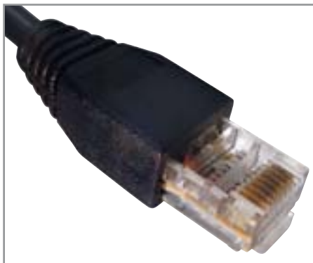
▲ Контакты соединительного кабеля желательно промыть спиртом
