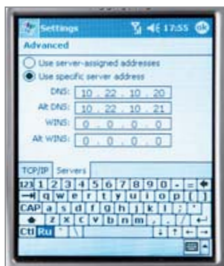
6.3 Выбираем «Servers» и заполняем DNS и WINS
