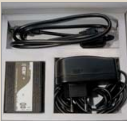
▲ В комплект входят мост, блок питания и соединительный кабель для подключения базовой трубки
