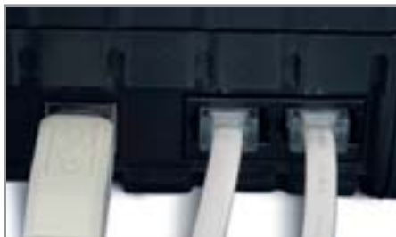
▲ Подключение: дата-порт ИБП не требователен к скорости, но USB (слева) для пользователя все равно удобнее, чем RS-232 (справа)
