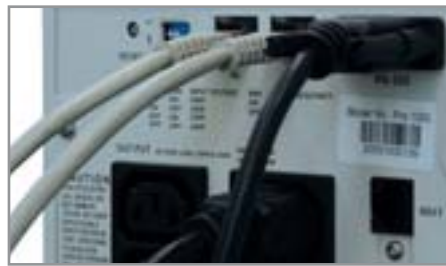
▲ Подключение: дата-порт ИБП не требователен к скорости, но USB (слева) для пользователя все равно удобнее, чем RS-232 (справа)
