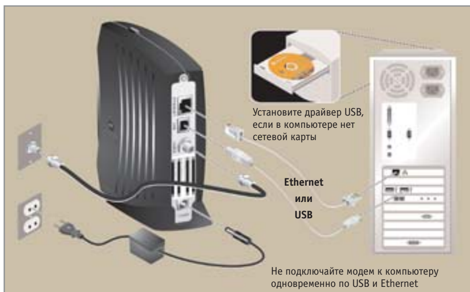
▲ Модем Motorola SB5100 можно подсоединять к персональному компьютеру по USB или через стандартный кабель Ethernet
