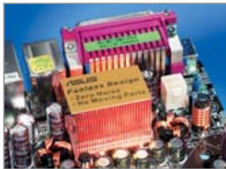
▲ Еще больше холода: высокое энергопотребление Pentium 4 (до 120 Вт) вынуждает дополнительно охлаждать преобразователи напряжения
