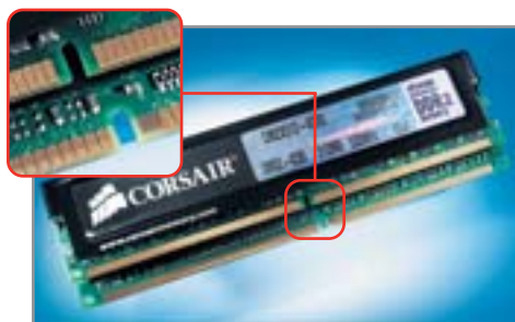
▲ Отличие: модули DDR2 (вверху) и DDR1 (внизу) отличаются только расположением ключа-выреза
