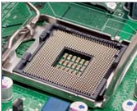
▲ Socket 775 немного больше предыдущей модели. Контактные ножки теперь находятся на сокетe
