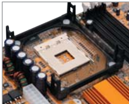
▲ Socket 478: стандартный сокет Intel окружен пластиковым «забором» фиксирующей рамки
