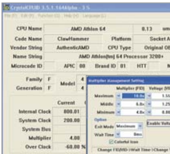
▲ Бесплатная утилита CrystalCPUID позволяет оперативно менять тактовую частоту в зависимости от нагрузки
