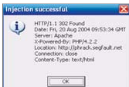
▲ Атака произошла успешно, обойдя встроенный брандмауэр Windows
