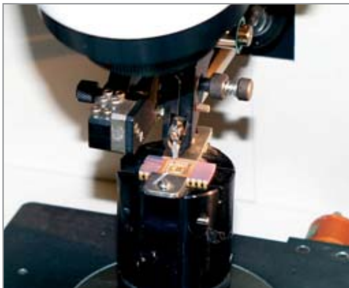
▲ Подключение: чип помещается в испытательный корпус и соединяется с его контактами
