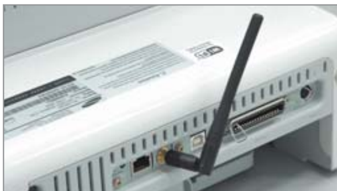
▲ Samsung ML-2252W: благодаря контроллеру Wi-Fi данный принтер можно использовать в беспроводной сети
