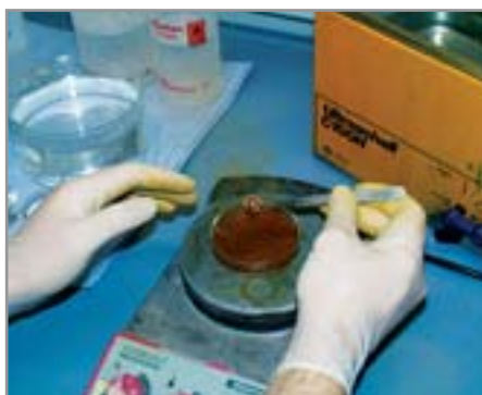
▲ В дымящейся азотной кислоте растворяется корпус, кремний при этом остается неповрежденным
