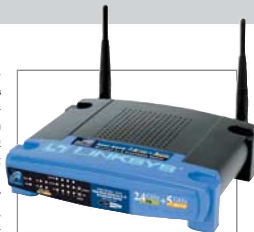
▲ Радиомаршрутизатор Linksys может работать в двух диапазонах: 2,4 ГГц (802.11g) и 5 ГГц (802.11a)
