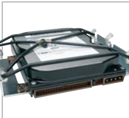
▲ Жесткий диск нужно разместить на звукоизолирующей платформе
