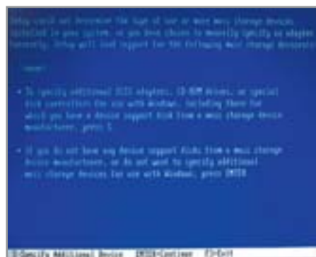
▲ Выбор драйвера: просто установите RAID-драйверы и продолжайте инсталляцию XP в обычном режиме
