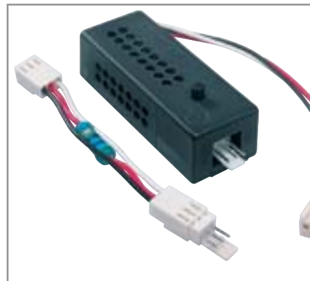
▲ Контроллер позволяет понизить напряжение питания вентиляторов
