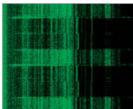
▲ Записанные с помощью микрофона сигналы компьютерного процессора
