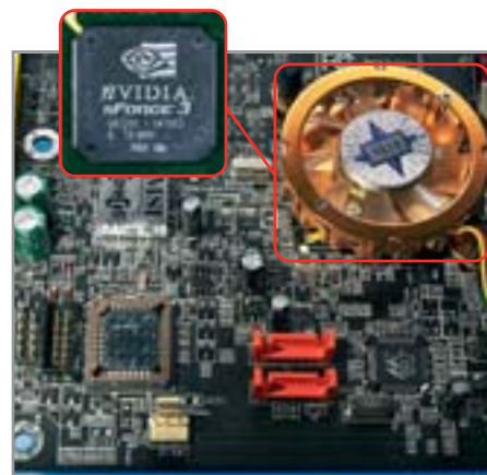
▲ Чип NVIDIA nForce 3 сочетает в себе, помимо чипсета, еще и полноценную реализацию RAID
