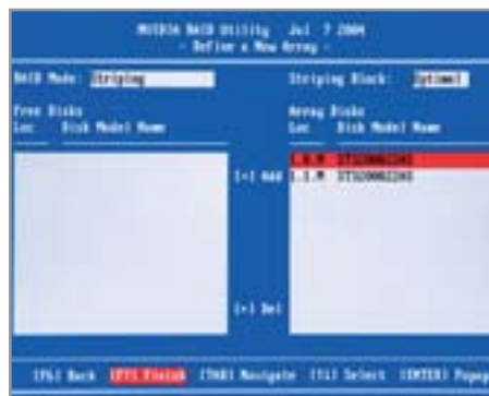
▲ Командный пункт RAID: в BIOS контроллера установите тип RAID-массива и размер блоков
