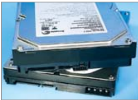
▲ Seagate отказалась от использования стандартного штекера Molex
