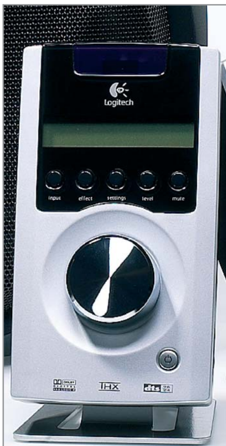
▲ Поехали: навигация в меню колонок Logitech осуществляется с помощью функционального колеса
