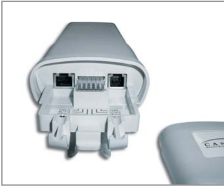
▲ Гнезда для подключения Сапору под нижней крышкой корпуса
