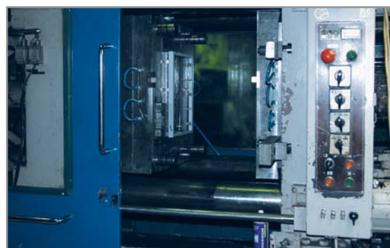
▲ Литейка: пластиковые корпуса для мониторов Prestigio P175 изготавливаются на месте. Их покраска также производится силами завода
