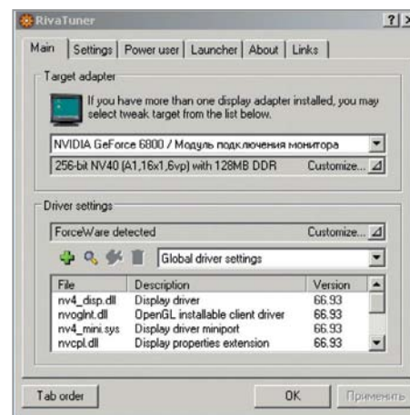
▲ Разблокирование конвейеров на плате GeForce 6800 в RivaTuner позволяет увеличить производительность
