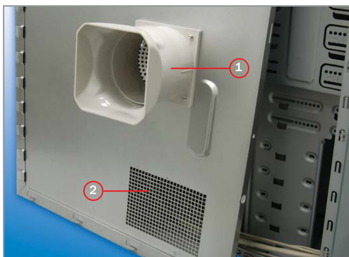
▲ Стенка современного корпуса должна обладать воздухопроводом (1) и вентиляционными отверстиями (2)
