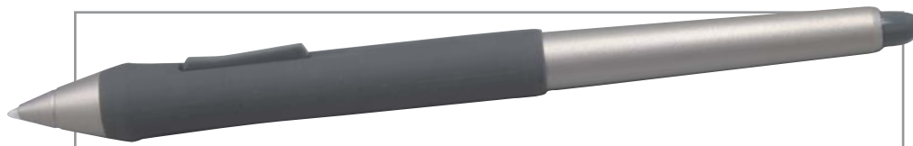
▲ Образец эргономичности: беспроводное перо из комплекта Wacom Intuos3 имеет два активных наконечника — собственно перо и ластик
