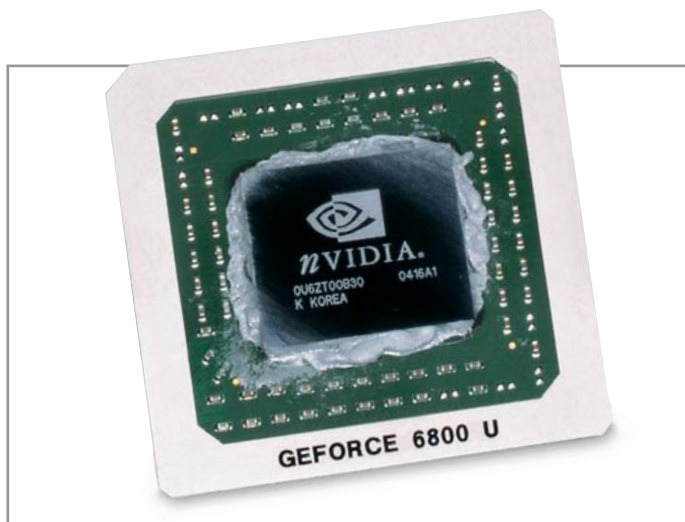
▲ GeForce 6800 Ultra содержит 222 миллиона транзисторов — абсолютный рекорд сектора High-End
