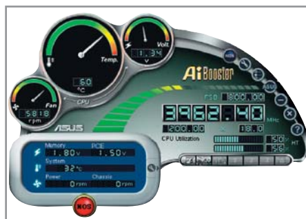
▲ При помощи AiBooster мы разогнали Pentium 4 с 3,6 до 3,96 ГГц
