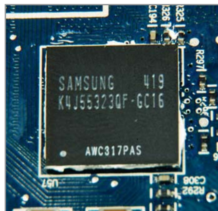
▲ Для высокой производительности необходима быстрая видеопамять, такая как Samsung GDDR3 1,6 нс
