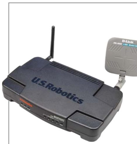
▲ Комнатная антенна DWL-R60AT подсоединяется без переходника
