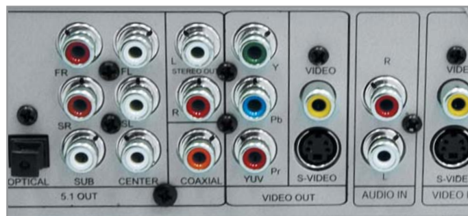
▲ Рекордер, оснащенный декодерами, можно напрямую подключать к активным акустическим системам
