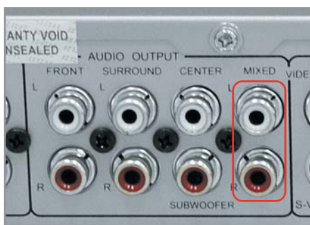
▲ Термином «Mixed» обозначен обычный стереовыход рекордера BKK
