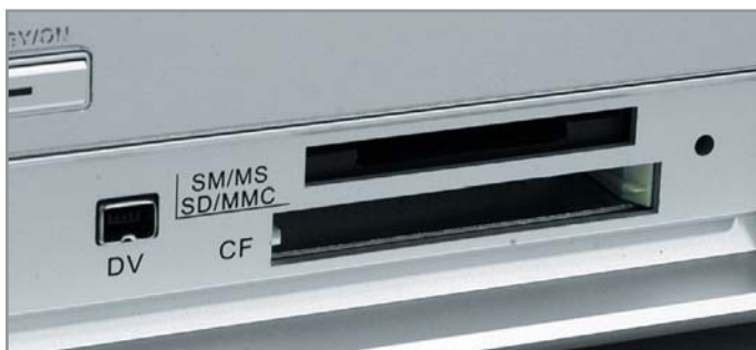
▲ Рекордер от BBK оснащен устройством для чтения карт памяти форматов SD, MMC, SM, MS и CF
