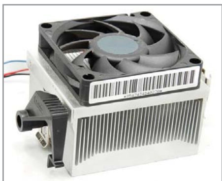
▲ Штатный кулер способен справляться с теплоотдачей всех Athlon 64
