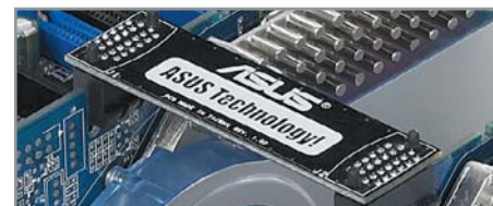
▲ Для ускорения обмена данными между двумя видеокартами используется особый мост
