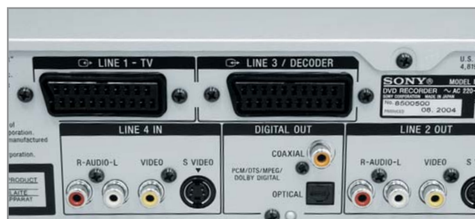
▲ Разъемы SCART могут работать в режимах входа и выхода — в зависимости от потребностей пользователя
