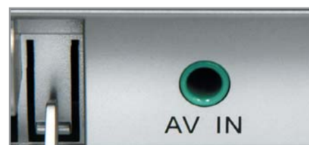
▲ Аудио- и видеовход рекордера BBK реализован через разъем mini-jack
