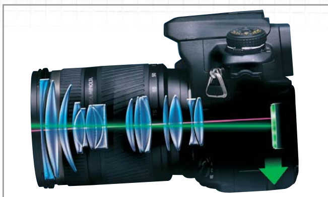
◀ Стабилизатор камер Konica Minolta двигает ПЗС-матрицу, а не группу линз, поэтому объективы остаются недорогими
