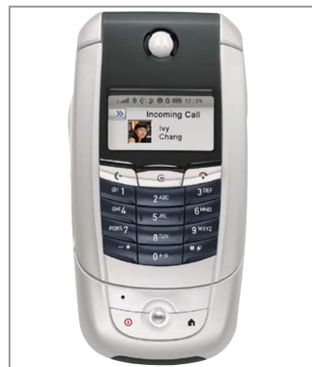
▲ Раскладушка A780 от Motorola с поддержкой EDGE на базе Linux
