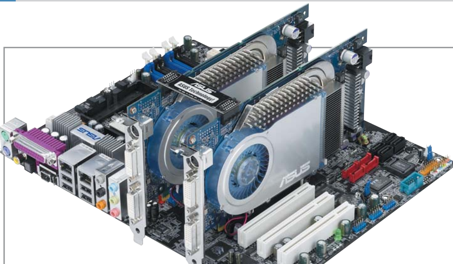
▲ Внешний вид платформы SLI: две видеоплаты занимают слишком много места и нуждаются в хорошем охлаждении
