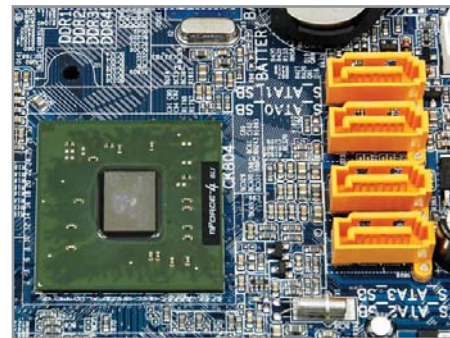
▲ nForce4 SLI и nForce4 Ultra оснащены контроллером Serial ATA II
