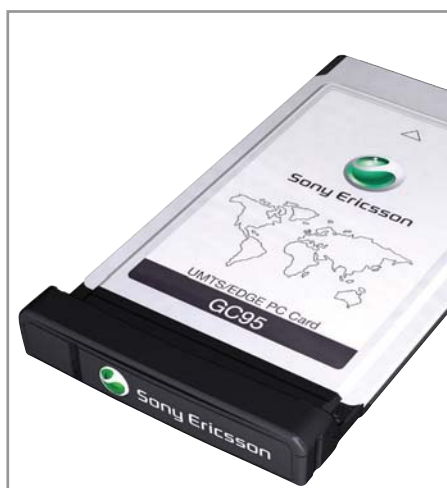
▲ Модуль Sony Ericsson GC95 для подключения ноутбука к EDGE
