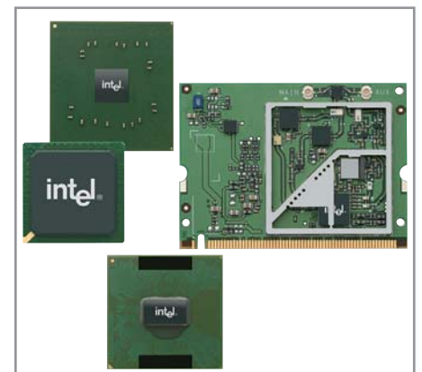
▲ Компоненты обновленной платформы Centrino: процессор, чипсет и адаптер беспроводных сетей
