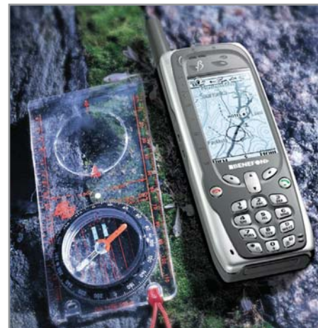
▲ Мобильный телефон Benefon ESC с 12-канальным GPS-приемником
