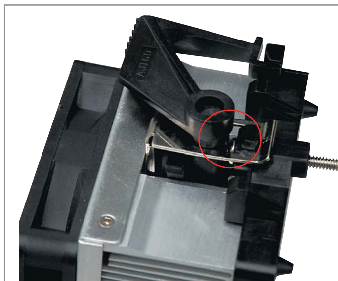
1.2 Доступ к головке болта, фиксирующего рамку, очень затруднен, поэтому открутить его нельзя
