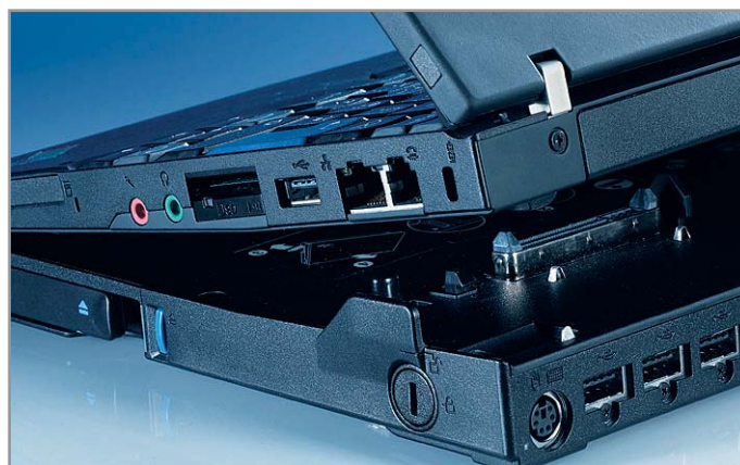
▲ Док-станция IBM добавляет ноутбуку несколько портов и такое важное устройство как оптический привод
