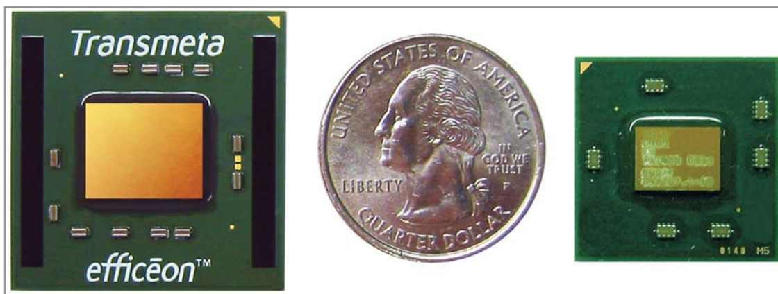
◀ Crusoe TM5900 (справа) и новый Efficeon TM8600 (слева) по габаритам сравнимы с 25-центовой монетой. Более поздняя модель чуть крупнее
