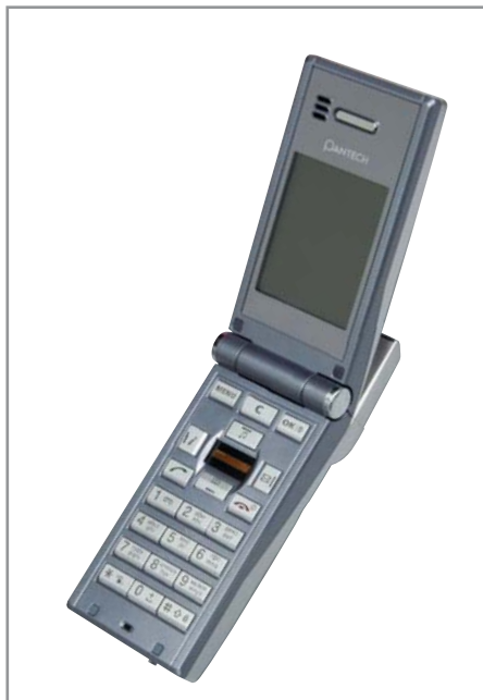
▲ На современные бизнес-модели телефонов (Pantech G100) и КПК (HP iPAQ hx2700) ставятся сканеры отпечатков пальцев
