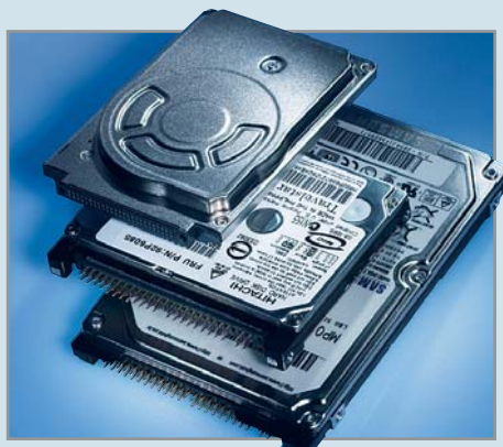
▲ Вместо 2,5-дюймовых дисков (снизу) в субноутбуках используются 1,8-дюймовые (сверху)
