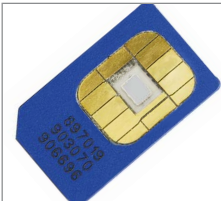
▲ В центре платы расположен микрочип на кремниевом кристалле
