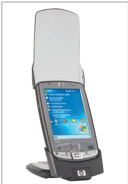
▲ На современные бизнес-модели телефонов (Pantech G100) и КПК (HP iPAQ hx2700) ставятся сканеры отпечатков пальцев
