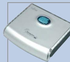
▲ Внешний жесткий диск Fujitsu-Siemens не требует отдельного питания и занимает мало места
