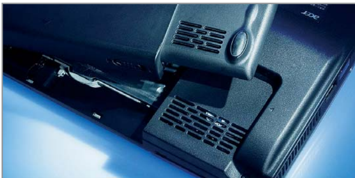
◀ Небольшое вентиляционное отверстие Acer еще больше уменьшается при установке аккумулятора
