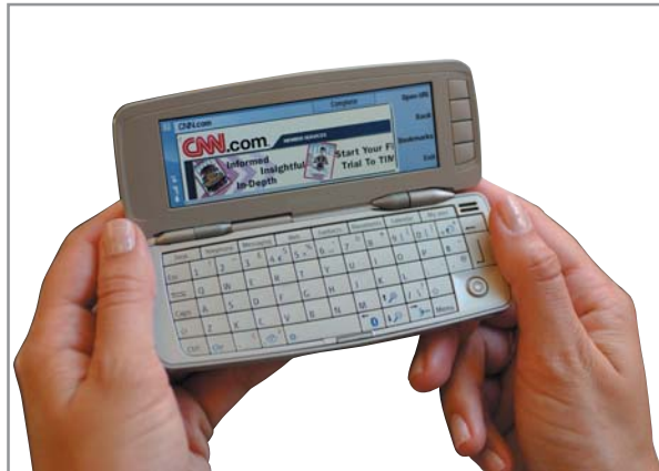
▲ TFT-дисплей на коммуникаторе Nokia 9300 имеет разрешение 640x200 точек, что обеспечивает отличную четкость изображения
