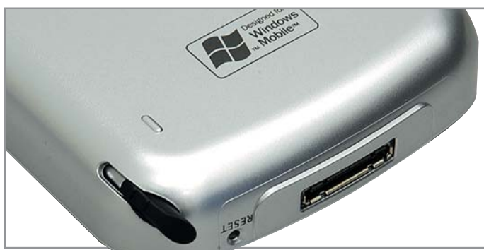
▲ Расположение стилуса внизу у модели MyPal A730W — не самое лучшее решение
