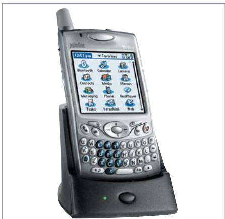
▲ Самое заметное улучшение в Treo 650 — это дисплей (320x320)
