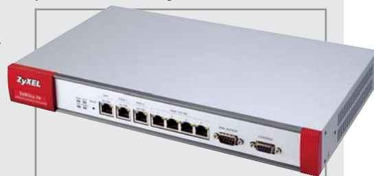
▲ Межсетевой экран ZyWALL 70W компании ZyXEL поддерживает протоколы SIP и H.323
