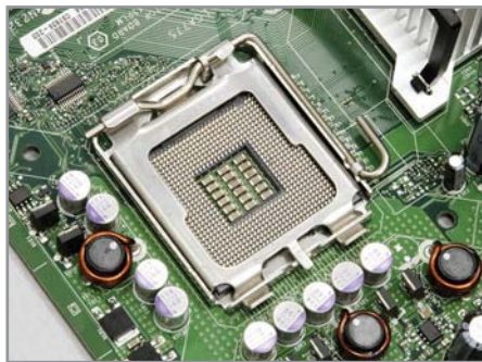
▲ Разъемы абсолютно одинаковы на вид, однако имеют разную разводку
