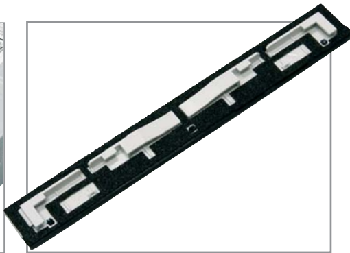
▲ Трей хорошего рекордера должен быть шумоизолирован
