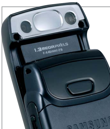
▲ Камера на слайдере Samsung SGH-D500E спрятана за сдвигающейся крышкой корпуса
