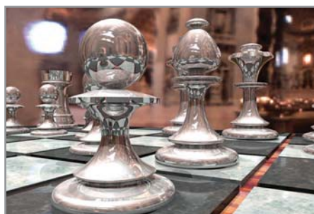
▲ Полезная функция трассировки лучей — корректная работа со сложными отражающими поверхностями
