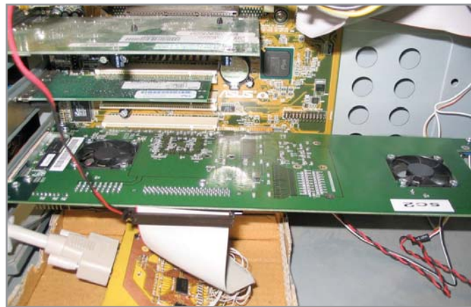
▲ Аппаратный ускоритель трассировки лучей SaarCOR был недавно представлен на CeBIT
