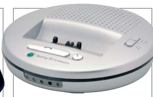
▲ Кредл DSS-25 удобен тем, что помимо обмена данными телефона с ПК обеспечивает зарядку батареи
