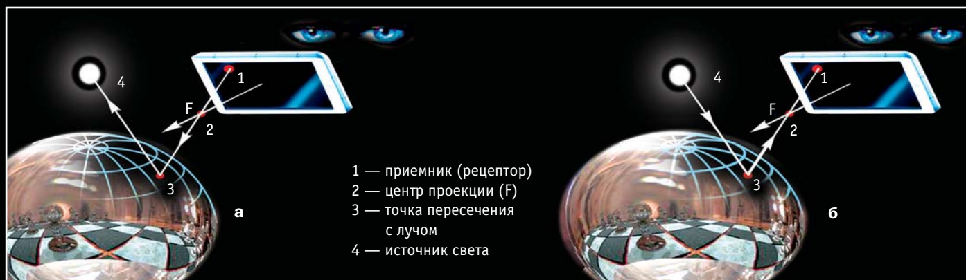
▲ Ход лучей при обратной (а) и прямой (б) трассировке
