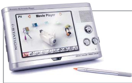
▲ Некоторые модели мультимедиаплееров уже оснащаются сенсорными ЖК-экранами
