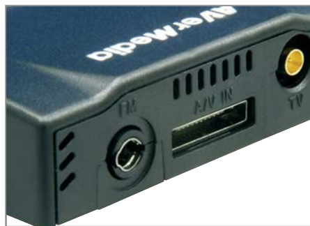
▲ AVerTV Cardbus Plus: подключение стандартных кабелей осуществляется через переходники
