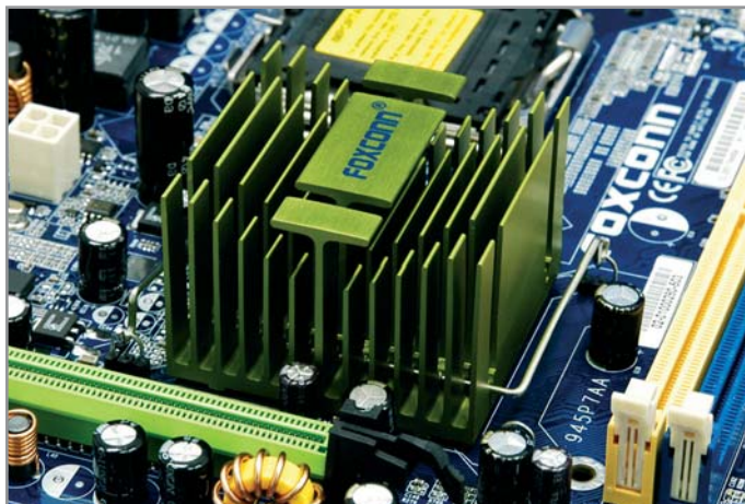
▲ Плата Foxconn 945P7AA оснащена невероятно большим радиатором, установленным на северном мосте
