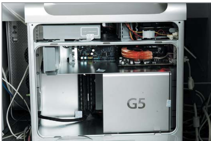
3.4 Теперь не греется: результат апгрейда кулера видео платы компьютера
