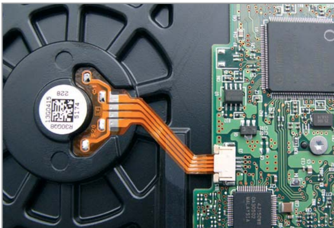
▲ При установке Hitachi Deskstar надо соблюдать осторожность: его электрические компоненты не защищены
