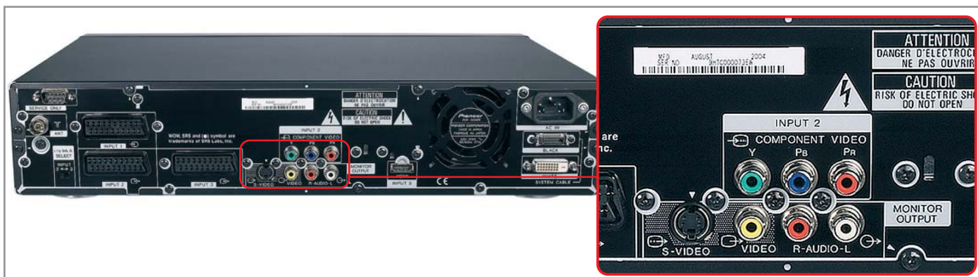
▲ Телевизор Pioneer комплектуется внешним медиаресивером. Его отличительной чертой является удобное расположение всех необходимых выходов, благодаря чему при подключении проводов не возникает никаких проблем
