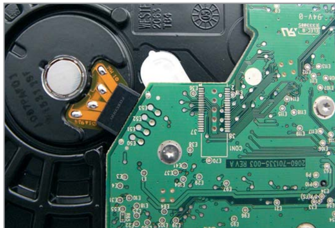
▲ Риск повредить диск от Western Digital немного ниже: микросхемы спрятаны под плату, шлейф закрыт
