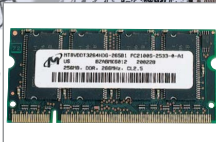
▲ Barebook-системы на базе чипсета Intel 855GM используют недорогую память DDR SDRAM PC2100
