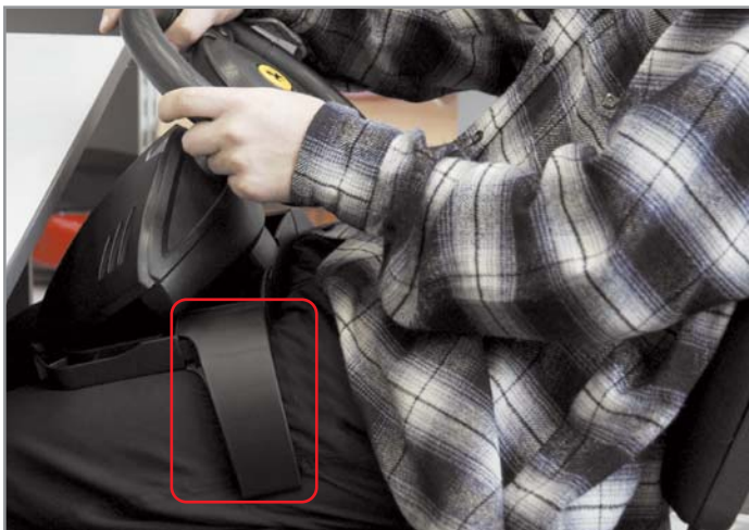
▲ Специальная подставка в комплекте к Thrustmaster Enzo Wireless позволяет держать руль на коленях
