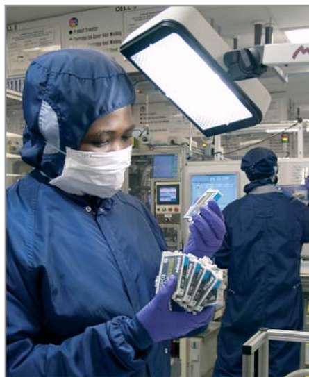
▲ Собранные картриджи подлежат обязательной проверке на предмет наличия каких-либо дефектов, которые могут повлиять на работу
