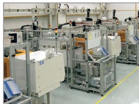
▲ В этом цеху происходит обработка пластика. Плавильные машины Nissei придают форму будущим картриджам
