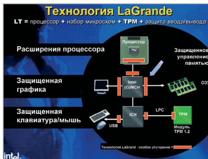
▲ Технология LaGrande контролирует почти все части ПК
