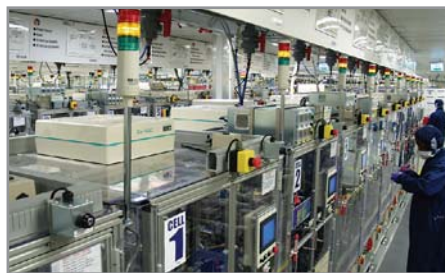
▲ Так выглядит цех сборки и заправки картриджей. Крупным планом показана сборочная линия картриджей раздельного типа
