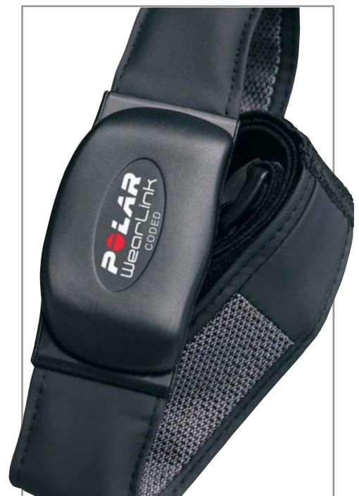
▲ В современных спортивных кардиомониторах датчик выполнен в виде нагрудной ленты
