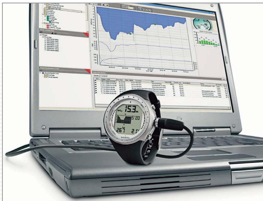
▲ Данные с компьютера Suunto D9 можно загрузить для анализа в свой персональный компьютер с помощью кабеля и специального софта
