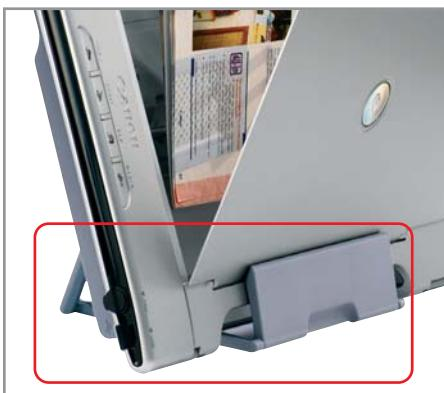
▲ С помощью штатной подставки сканер CanoScan LiDE 500F может работать в вертикальном положении
