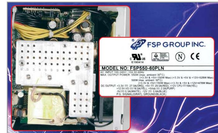
▲ FSP FSP550-60PLN: радиаторы системы охлаждения передают нагрев на стенки корпуса
