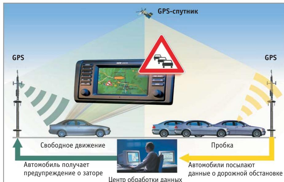
▲ Система Floating Car Data (FDC), разработанная компанией BMW для передачи информации о заторах, использует технологии GSM и GPS
