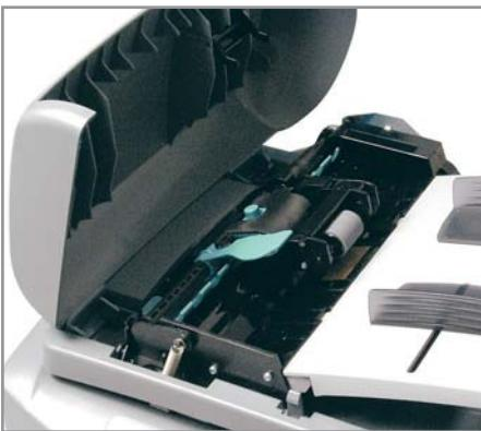
▲ **Сканер HP ScanJet 7650** оснащен универсальным устройством автоматической подачи документов
