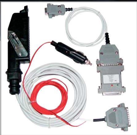
▲ Переходник, предназначенный для обновления микропрограммного обеспечения контроллеров «Январь» и Bosch
