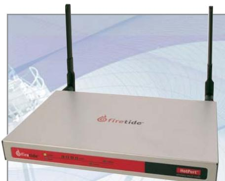
▲ Маршрутизатор HotPort 3100 Series компании Firetide разработан для построения Mesh-сетей
