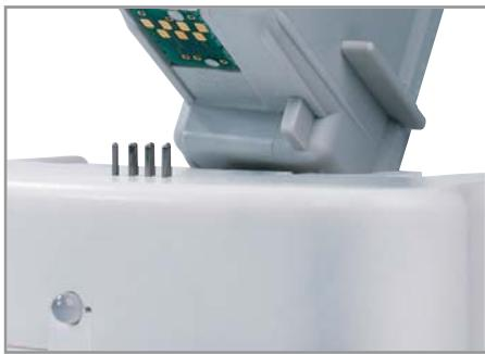
▲ С помощью так называемого перепрограмматора можно обнулить счетчик чернил
