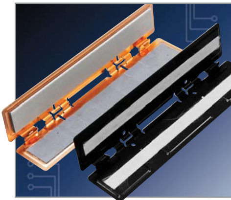
▲ Под радиаторами оперативной памяти размещены диэлектрические прокладки, а не термоинтерфейс
