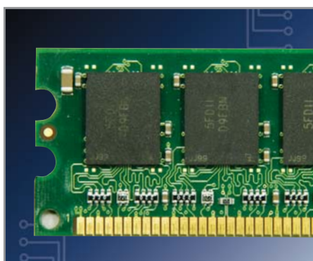
▲ Модули Crucial CT6464Z40B.M8FD содержат микросхемы Micron Technology 5FD11 D9FBN в корпусах BGA
