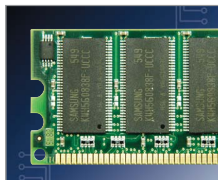
▲ Модули Samsung M368L6423FUN-CCC содержат микросхемы K4H560838F-UCCC, не поддающиеся разгону
