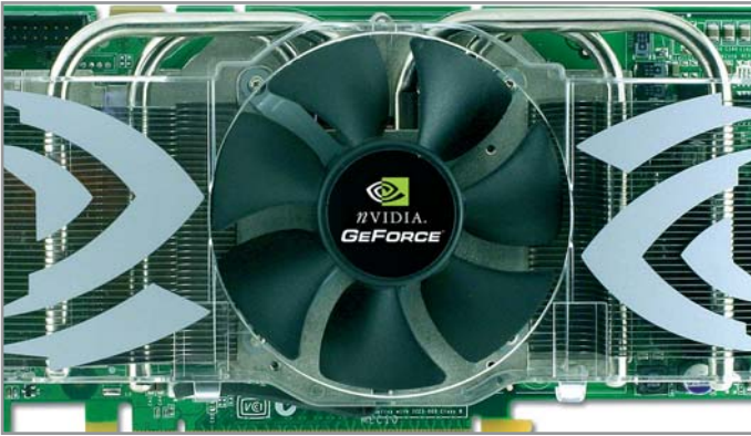
▲ Массивная система охлаждения Gainward GeForce 7800 GTX работает практически бесшумно
