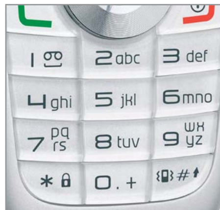
▲ Выпуклые клавиши ОТ 757 имеют четко выраженный центр нажатия, но сильно качаются в гнездах
