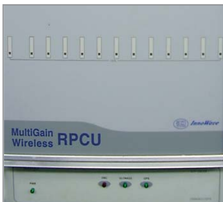
▲ MGW — блок управления радиопортами цифровой системы абонентского радиодоступа
