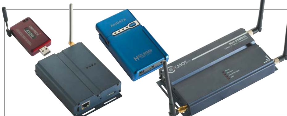
7 CDMA-модемы и мосты обеспечивают прием данных на скорости до 2,4 Мбит/с и передачу — до 153 кбит/с
