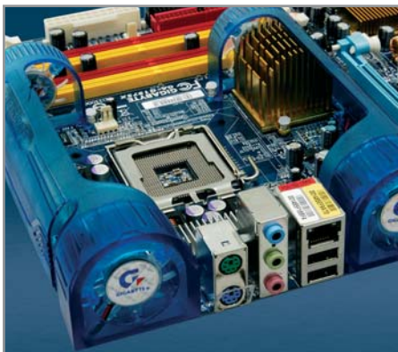
▲ Уникальная система охлаждения сети питания процессора и северного моста от Gigabyte
