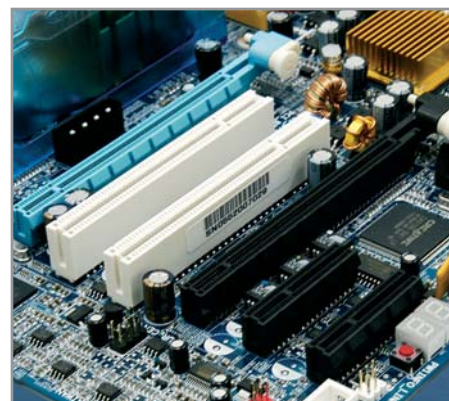
▲ У Gigabyte GA-G1975X имеются в общей сложности четыре слота для графических плат
