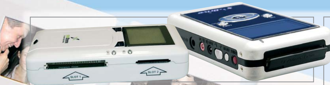
▲ Некоторые устройства укомплектованы различными заглушками, предотвращающими попадание пыли внутрь, а некоторые — нет. На фото: Vsonic VP-3620 и StorXtreme SX-25D
