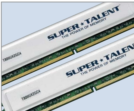
▲ Super Talent T800UX2GC4: такая память может работать при частоте 1100 МГц и напряжении питания 2,3 В
