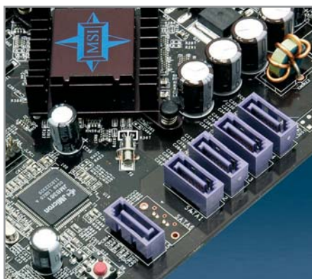
▲ На плате MSI 975X Platinum H расположено пять портов SATA, хотя имеется место и под шестой
