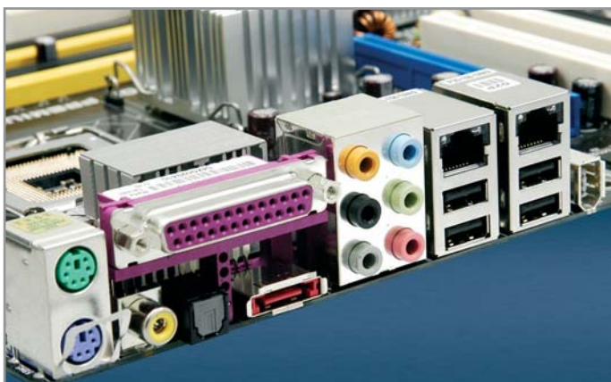
▲ На задней панели платы ASUS P5WD2 Premium есть все, что только может пригодиться, даже один разъем SATA
