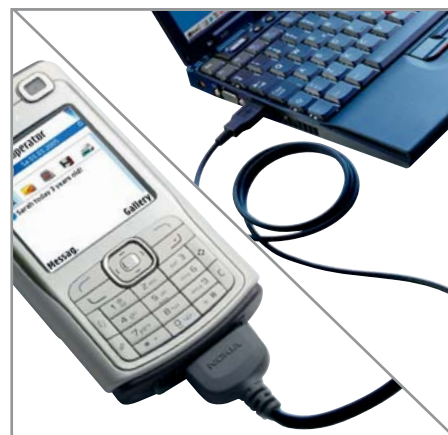
▲ Связь смартфона N70 с другими устройствами обеспечивается по USB 2.0 (на скорости 12 Мбайт/с)
