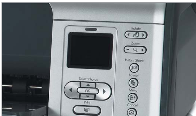
▲ Принтер HP Photosmart 8053 укомплектован ЖК-дисплеем, на который выводится основная информация или отображается печатаемая фотография
