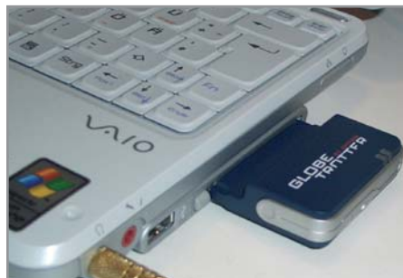
▲ С узла Evolium A9100 данные передавались на ноутбук Sony, оснащенный PCMCIA-картой Option
