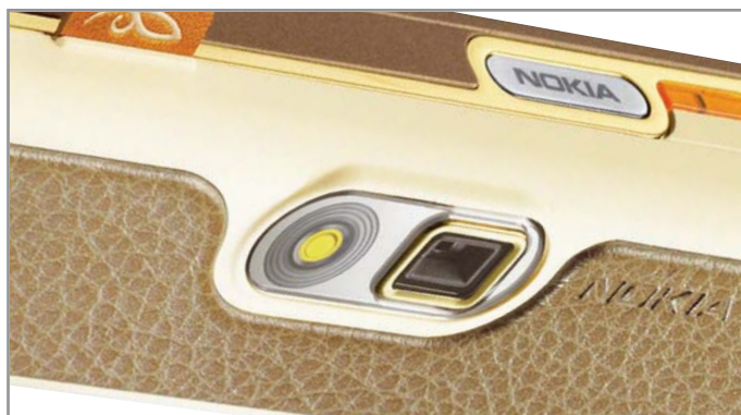
▲ На задней крышке корпуса «батончика» Nokia 7380 расположена двухмегапиксельная камера
