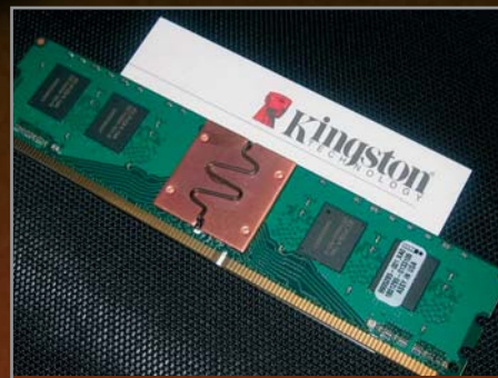
▲ На FB-DIMM-модулях радиатором прикрыт только буферный чип, работающий с высокой частотой
