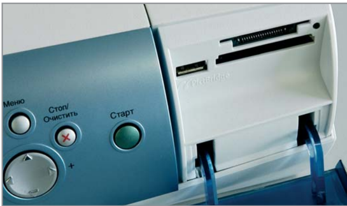
▲ Принтер Lexmark P915 оснащен устройством для чтения фотографий с карт памяти и USB-разъемом для подключения камеры
