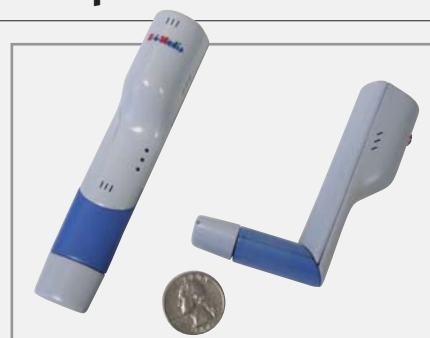
▲ UWB-адаптер, созданный компанией Global Interface Technologies, работает на частоте 3,1–10,6 ГГц
