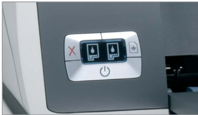
▲ Управлять принтером HP DeskJet 5743 просто и удобно — на панели присутствуют лишь пара клавиш и светодиодный индикатор
