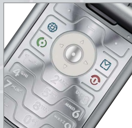
▲ Motorola заменила клавиши обозначенными на металлической поверхности контурами кнопок
