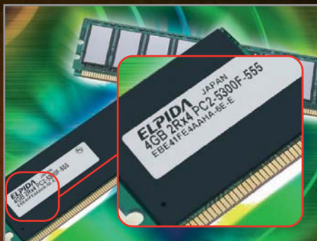
▲ Уже сегодня модули FB-DIMM объемом 4 Гбайт каждый — обычное дело
