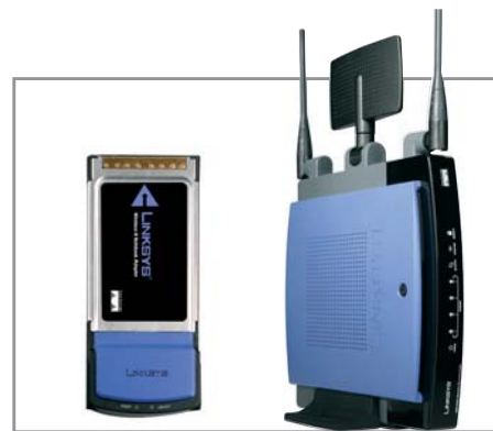
▲ Необычные антенны роутера WRT300N производства Linksys необходимы для полноценного использования технологии MIMO
