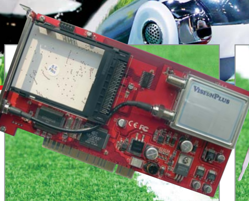
▲ Некоторые модели ресиверов, такие как TwinHan VisionPlus, оснащены приемником для карт оплаты
