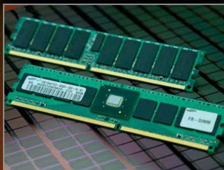
▲ Модули FB-DIMM могут комплектоваться чипами памяти в любой корпусировке
