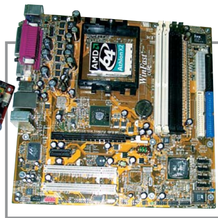
▲ Плата mini-ATX на чипсете NVIDIA для процессоров AMD (Socket 939)
