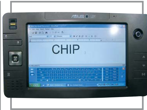
▲ ASUS R2H построен на базе процессора Intel Celeron M ULV 900 МГц
