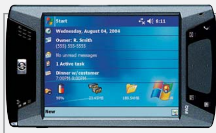
▲ HP iPAQ hx4700 оснащен TFT-дисплеем стандарта VGA (640x480) с диагональю экрана 4 дюйма
