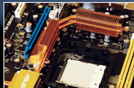
▲ У платы ASUS пассивная система охлаждения чипсета
