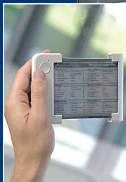
▲ Philips Readius: сворачивающийся дисплей позволил придать PDA-прототипу новый вид — экран намного больше самого устройства
