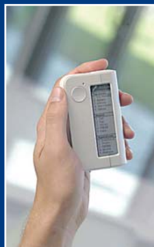
▲ Philips Readius: сворачивающийся дисплей позволил придать PDA-прототипу новый вид — экран намного больше самого устройства
