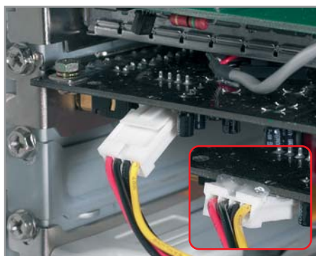
1 При помощи капли клея разъем на Audigy фиксируется в правильном положении
