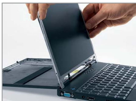
1.2 Механическое соединение устранено, панель и ноутбук связывают только провода
