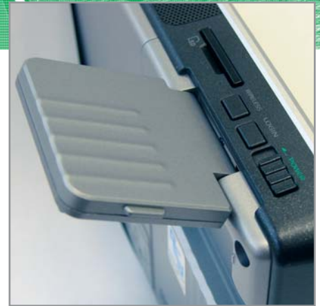
▲ Откидная антенна GPS-приемника регулируется в одной плоскости
