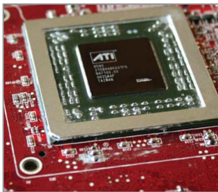
▲ Чип R580+ в окружении микросхем памяти GDDR4 производства Samsung со временем доступа 0,9 нс
