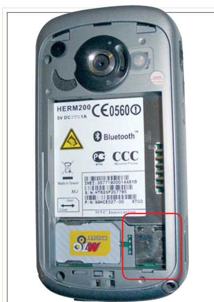
СЛОТ КАРТ ПАМЯТИ ФОРМАТА MICROSD расположен в нижней части корпуса HTC TyTN, рядом с гнездом для SIM
