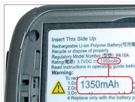
АККУМУЛЯТОР В коммуникаторе HTC TyTN установлен аккумулятор емкостью 1350 мАч, который обеспечивает работу до 5 часов
