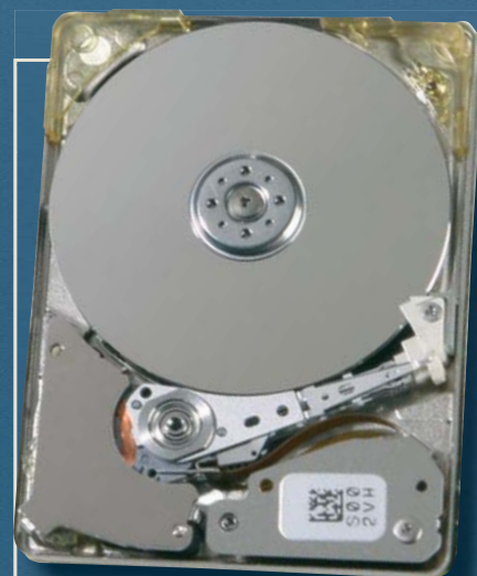
MICRODRIVE Современный компактный жесткий диск даже в режиме бездействия потребляет столько же энергии, сколько флеш-карта в режиме записи
