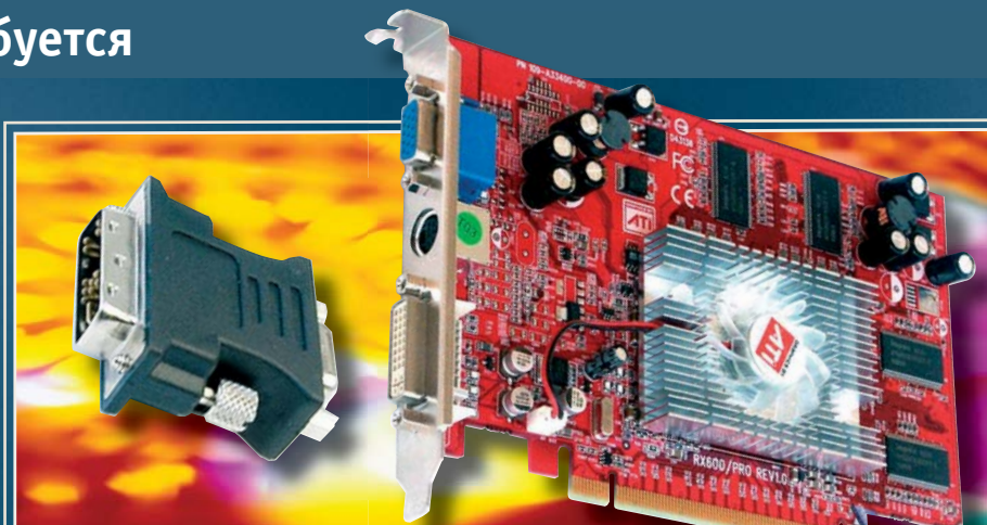
Цифровой разъем DVI и аналоговый VGA (на фото слева). Адаптер позволит подключить к этой графической плате два электронно-лучевых монитора
