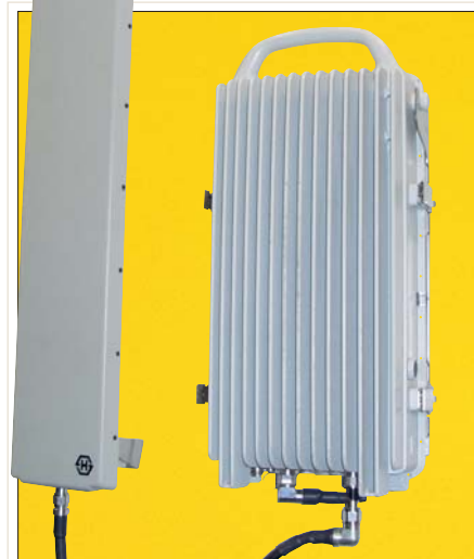
ВНЕШНИЕ БЛОКИ И АНТЕННЫ WiMAX заметно отличаются своими габаритами от привычного нам Wi-Fi-оборудования
